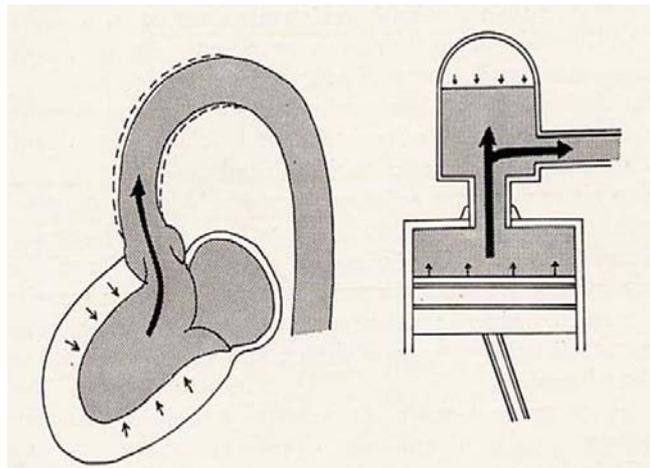
L'effet Windkessel (Wind = air et Kessel = citerne) était utilisé, à titre d'exemple, au début du siècle passé par les pompiers. Ils utilisaient une pompe dotée d'une activité rythmique, mais, cependant, cet appareil était en mesure de fournir un flux continu d'eau pour éteindre les incendies. Dans la phase de
