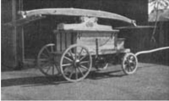
compression, seulement une partie de l'eau est poussée vers l'extérieur, le reste étant stocké dans une chambre fermée remplie d'air. Ici l'air est donc comprimé, et dans la phase de décompression de la pompe, c'est l'air qui va pousser l'eau à l'extérieur. Le résultat est l'expulsion d'un flux d'eau continu.
