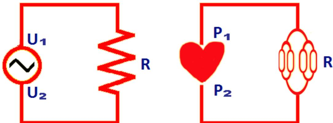
La loi d'Ohm dit que dans un système électrique fermé la différence de potentiel entre le début et la fin du système ( $\Delta U = U_2 - U_1$ ) est donnée par l'intensité du courant fourni ( $I$ ) multipliée par la résistance du système ( $R$ ).
