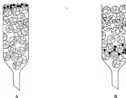
Figure 5 : Principe de la filtration sur gel
