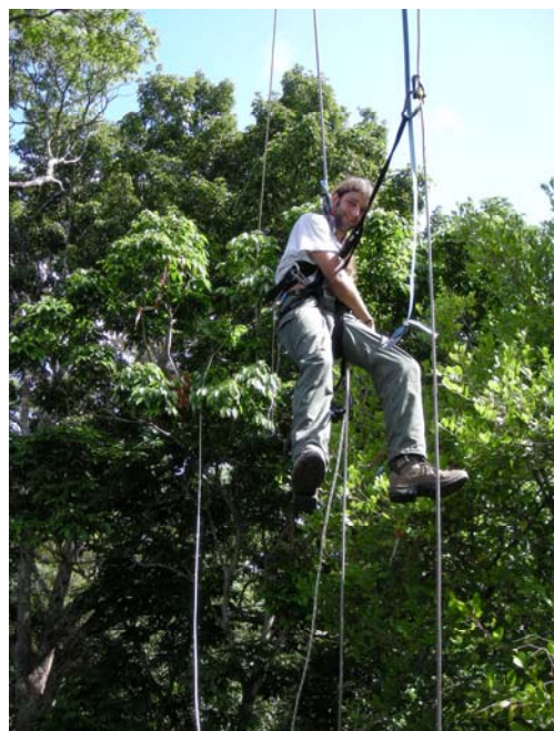
Figure 9 : Système de cordage permettant à un opérateur, suspendu à la tour, d'avoir accès au houppier des arbres à proximité de la tour et de faire des mesures d'échanges gazeux.
