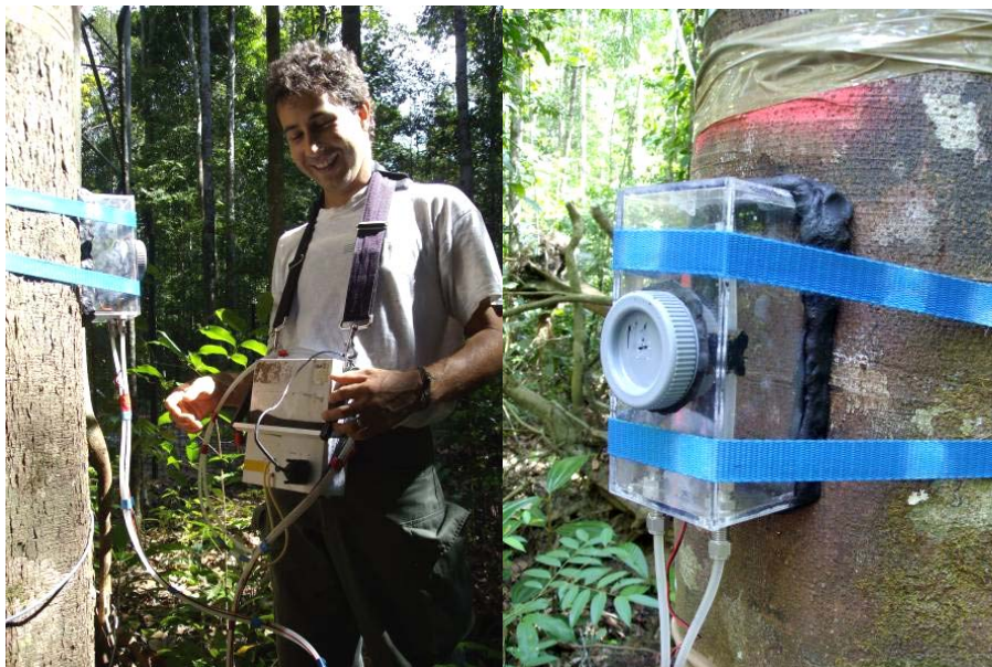
Figure 16 : Mesure de l'efflux de CO 2 des troncs en circuit fermé avec un analyseur de gaz à infra rouge (IRGA, EGM PP-system) et chambre de respiration (fabriqué au laboratoire).
