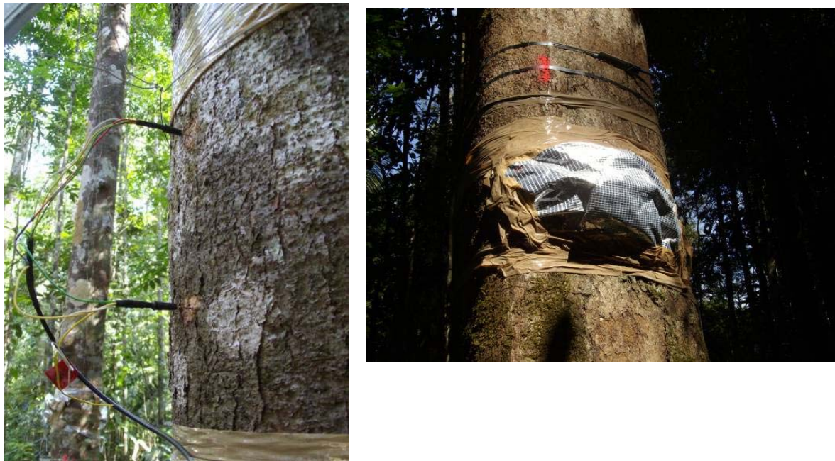
Figure 12 : Mise en place des capteurs de flux de sève et poche de protection des capteurs en feuille de mousse aluminisée contre le rayonnement et la pluie.
