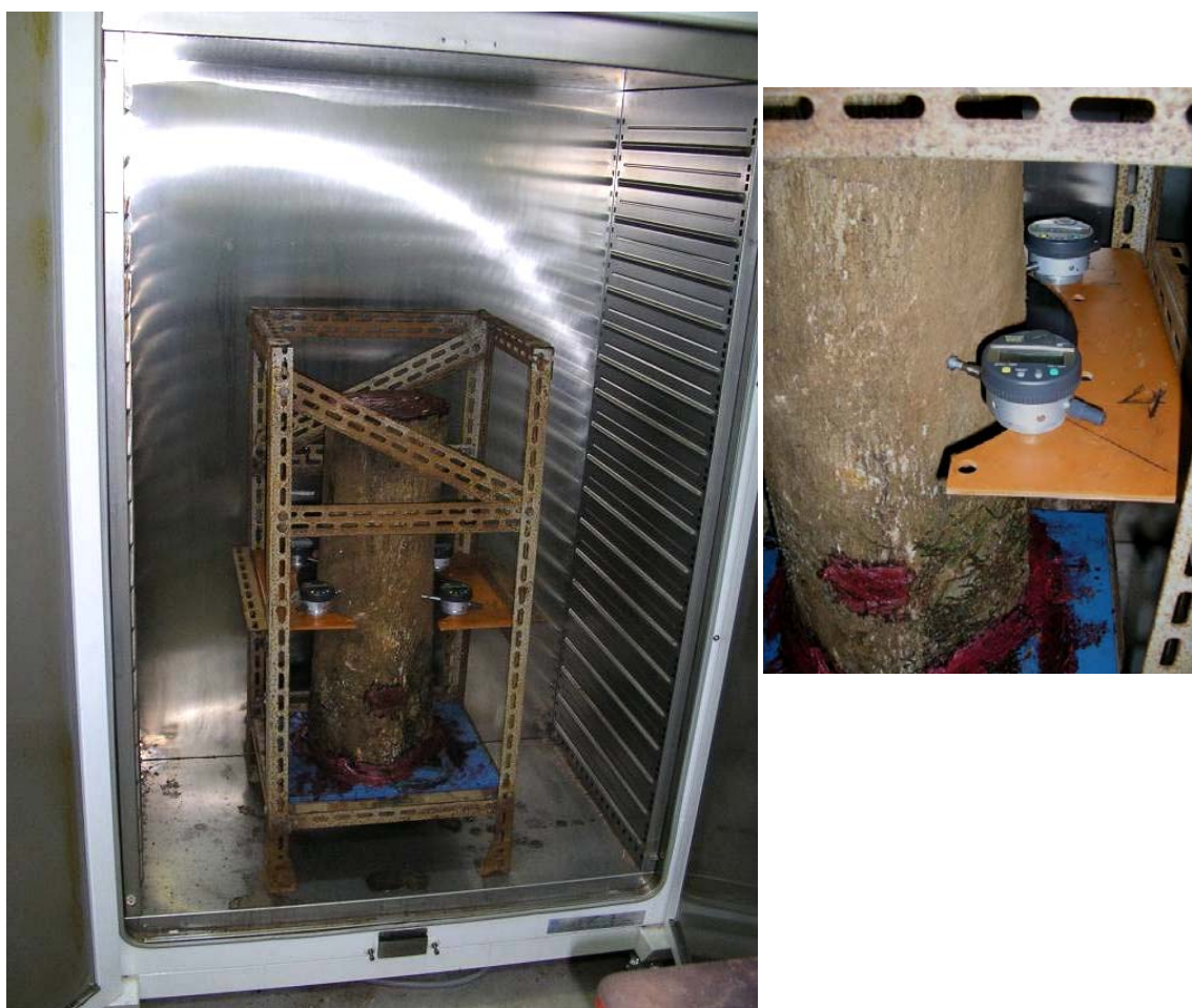
Figure 11 : Dispositif expérimental au laboratoire de Pariacabo. Billot de tronc d'arbre placé dans une chambre climatique avec capteurs de déplacement.
