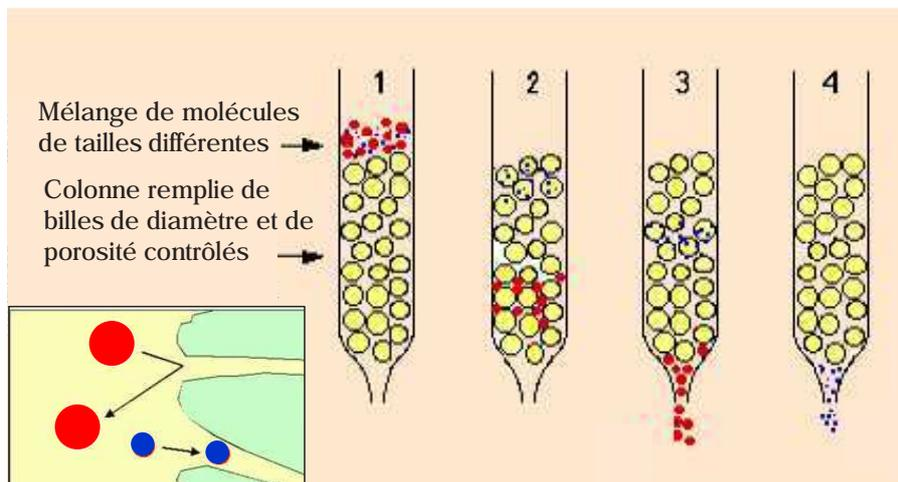
Figure 15 : Schéma du principe de la GPC
