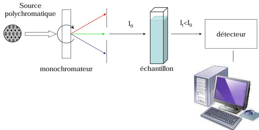
Figure 21 : Schéma du principe de mesure par spectrophotométrie
