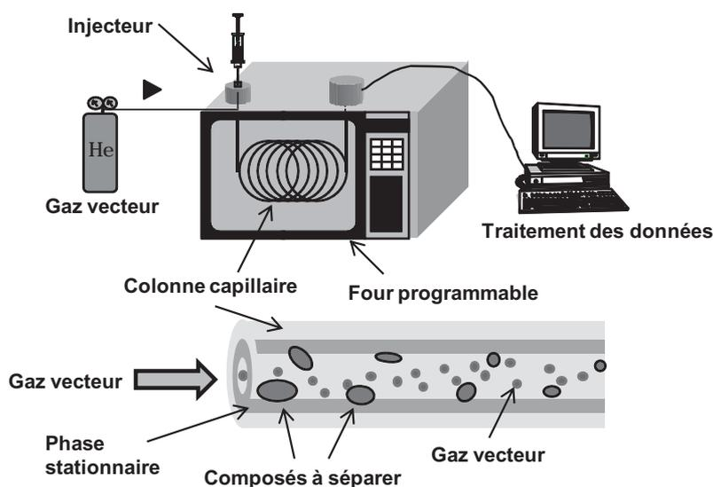
Figure 11 : Schéma du principe de la chromatographie en phase gazeuse
