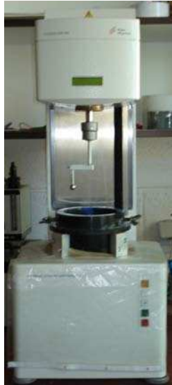
Figure 31 : Rhéomètre Paar Physica UDS 200 [121] muni du Système de Mesure à Boule.
