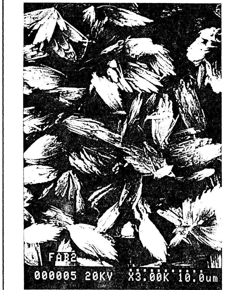
Figure 26 : Microscopie électronique à balayage de la poudre du dépôt de rétentat de microfiltration (images S.E.). (a) : Grossissement de 300 ; (b) : Grossissement de 3000.
