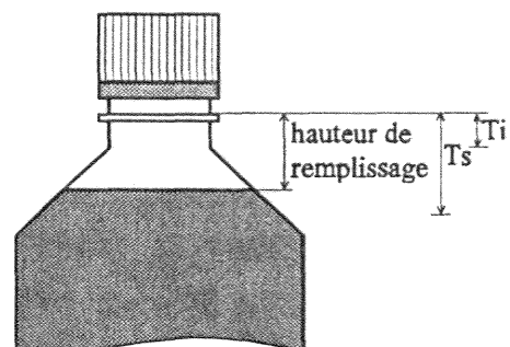
Figure II.17 : Définition de la hauteur de remplissage
