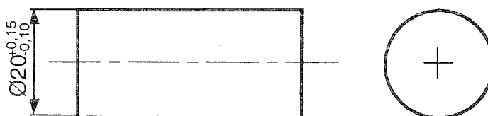
Figure 1.6 : Spécification linéaire sur une surface nominalement cylindrique
