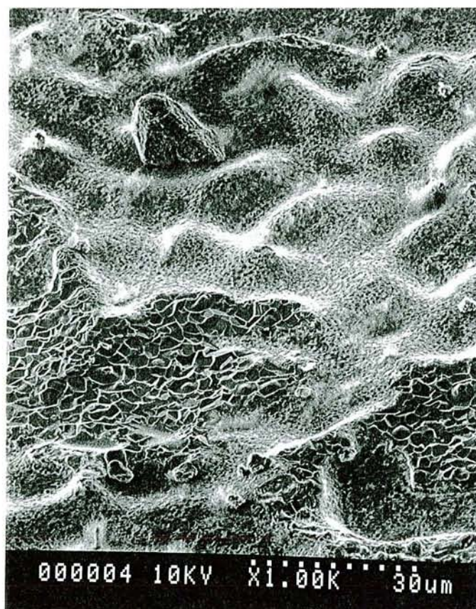
Figure V-25 : Surface du substrat (\text{Pd}_{0.6}\text{Ni}_{0.4})\text{Al} avec 2% Cr oxydé 300h à 1200^\circ\text{C} après décollement de la couche d'oxyde.
