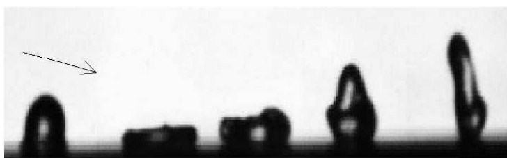
FIG. IV.5 – Déformation d'une goutte d'eau : D_g = 150 \mu\text{m} , V_n = 2 \text{ m.s}^{-1} , f_{inj} = 10 \text{ kHz} , T_p = 500^\circ\text{C} .
