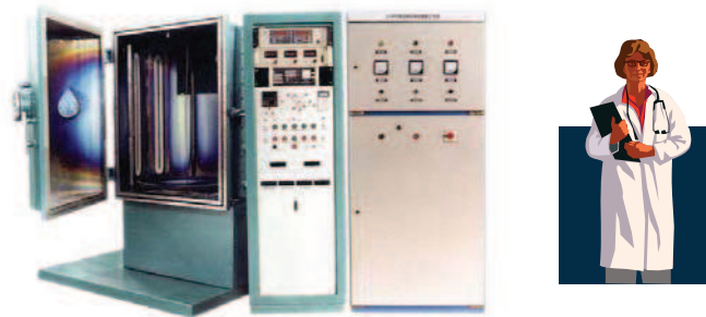
FIG. 2.8 – a/ Exemple de réacteur de dépôt industriel pour l'industrie de l'automobile ( Sichuan Goldstone Orient New Material Equipment Co., Ltd., Chine ).
