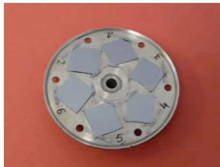
FIG. 2.14 – Photographie de la plateforme support des substrats. Ici on peut voir six substrats de silicium prêts pour le dépôt.
