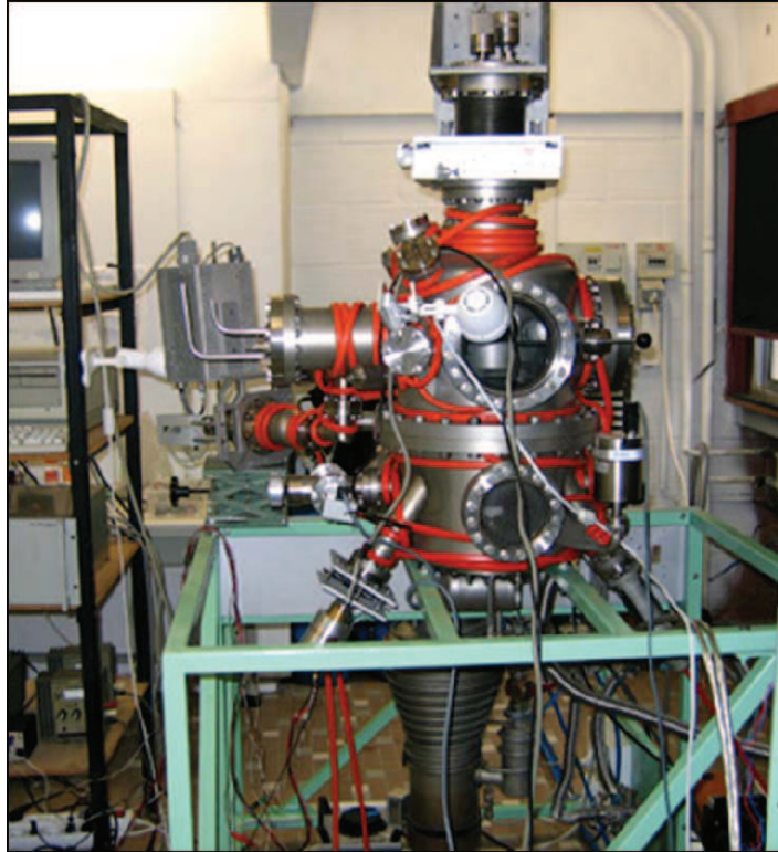
FIG. 2.11c – Photographie du réacteur de pulvérisation cathodique réactive RF fonctionnant sous ultra-vide (boîtier d'alimentation du magnétron absent).
