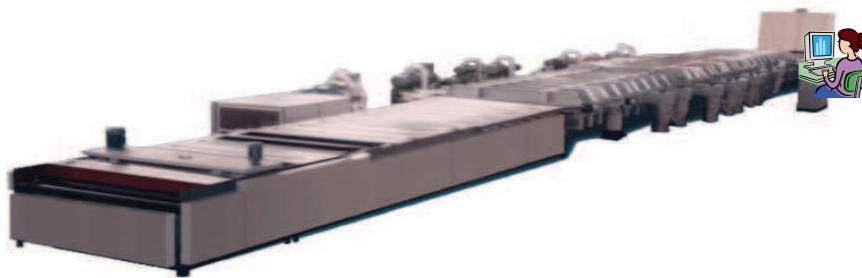
FIG. 2.8 – b/ Exemple de ligne de production industrielle de pulvérisation magnétron pour l'industrie du verre (ETA Film Technology Inc., Taiwan).
