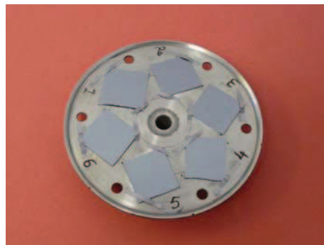
FIG. 2.14 – Photographie de la plateforme support des substrats. Ici on peut voir six substrats de silicium prêts pour le dépôt.
