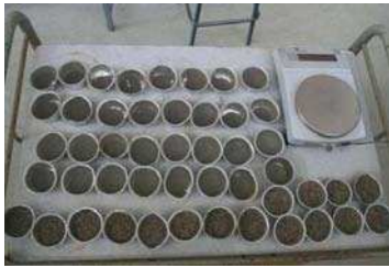
Pesée des échantillons secs
