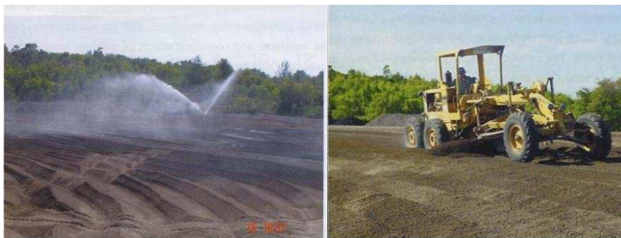
Fig. 1. 29 : Procédé ACERITA, vieillissement naturel du laitier LD [DA SILVEIRA et al. , 2005]
