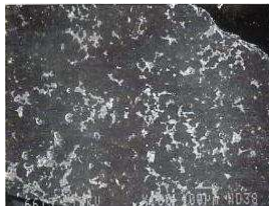
Fig. 1. 18 : Distribution de CaO sous forme d'amas disséminés (phase blanche) [HORNAIN, 1995]
