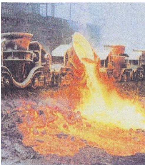
Fig. 1. 3: Coulée du laitier d'aciérie de conversion dans une fosse
