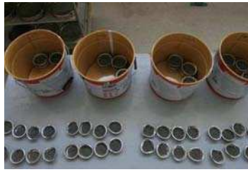
Immersion des échantillons dans les seaux
