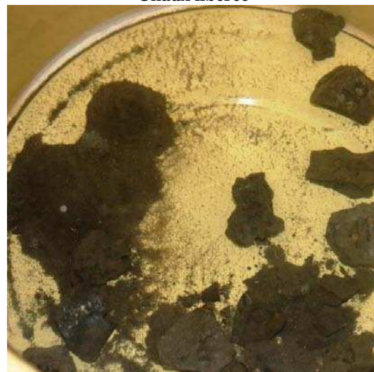
50/63, 10 jours, 60°C Suivi de la dégradation
