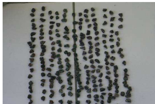
Fig. 2. 98: Numérotation des 1020 grains BS1 (fraction 10/12,5/)
