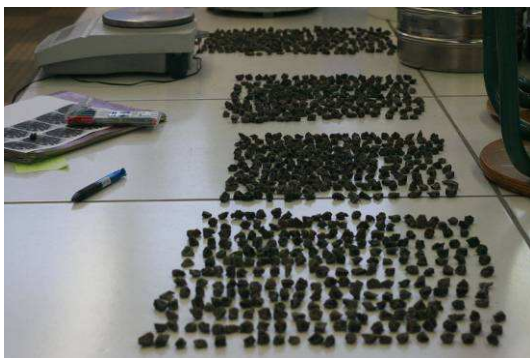
Fig. 2. 8: Pesée des 1020 grains BS1 (fraction 10/12,5)
