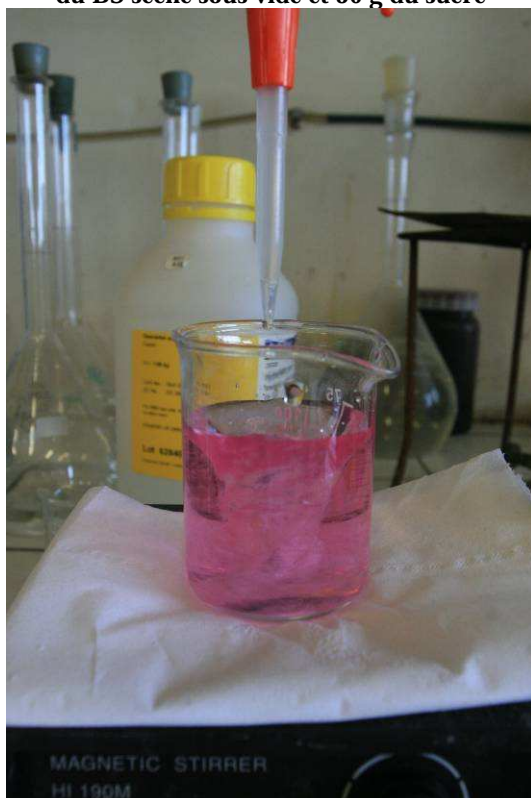
Solution filtrée colorée par phénophtaléine avant ajout de HCl
