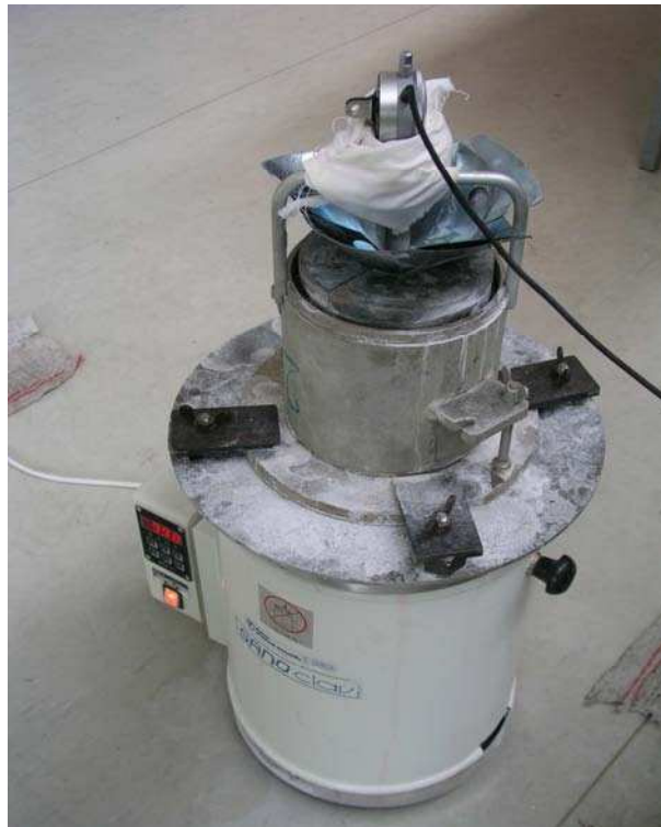
Fig. 4. 5 : Appareil pour l'essai d'expansion à la vapeur, en cours de mise au point
