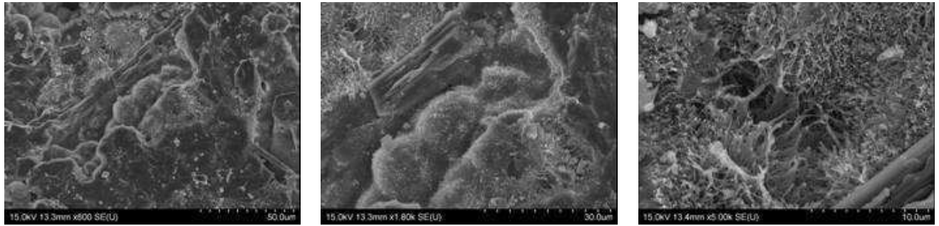
Fig. 4. 10 : Micrographies MEB du laitier BS2 après l'essai à la vapeur
