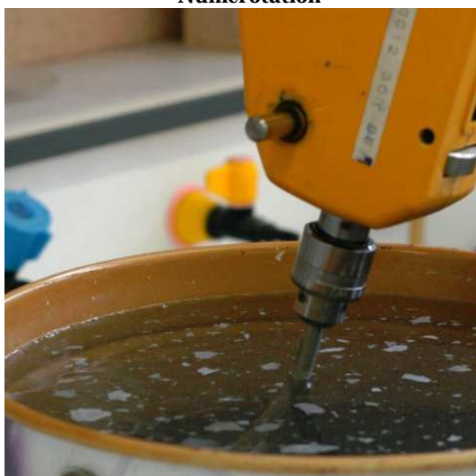
Agitation Titration de la chaux libérée
