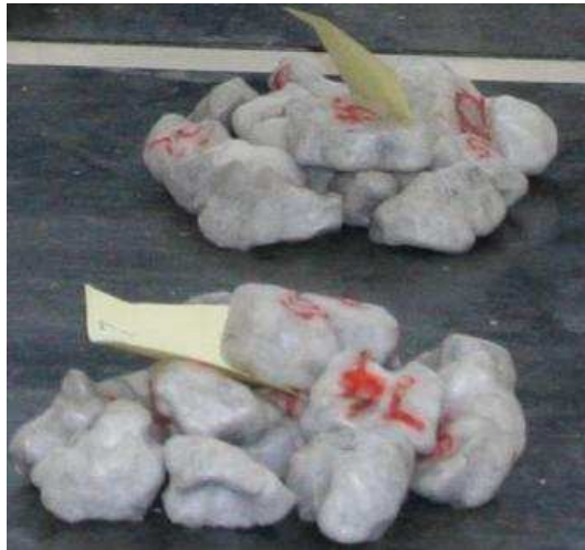
Fig. 2. 16: grains de LAC enveloppés par la paraffine et numérotés pour mesurer la MVR
