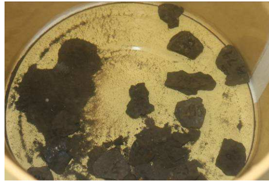
Dégradation par pulvérisation des grains (grains généralement poreux)
