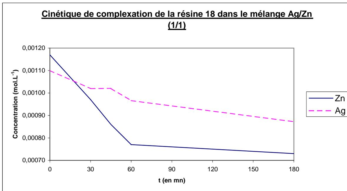
**Figure 161 :** Complexation simultanée des ions  $\text{Ag}^+$  et  $\text{Zn}^{2+}$  par la résine **18**. MeOH/H<sub>2</sub>O 9/1. 50 mg **18**
