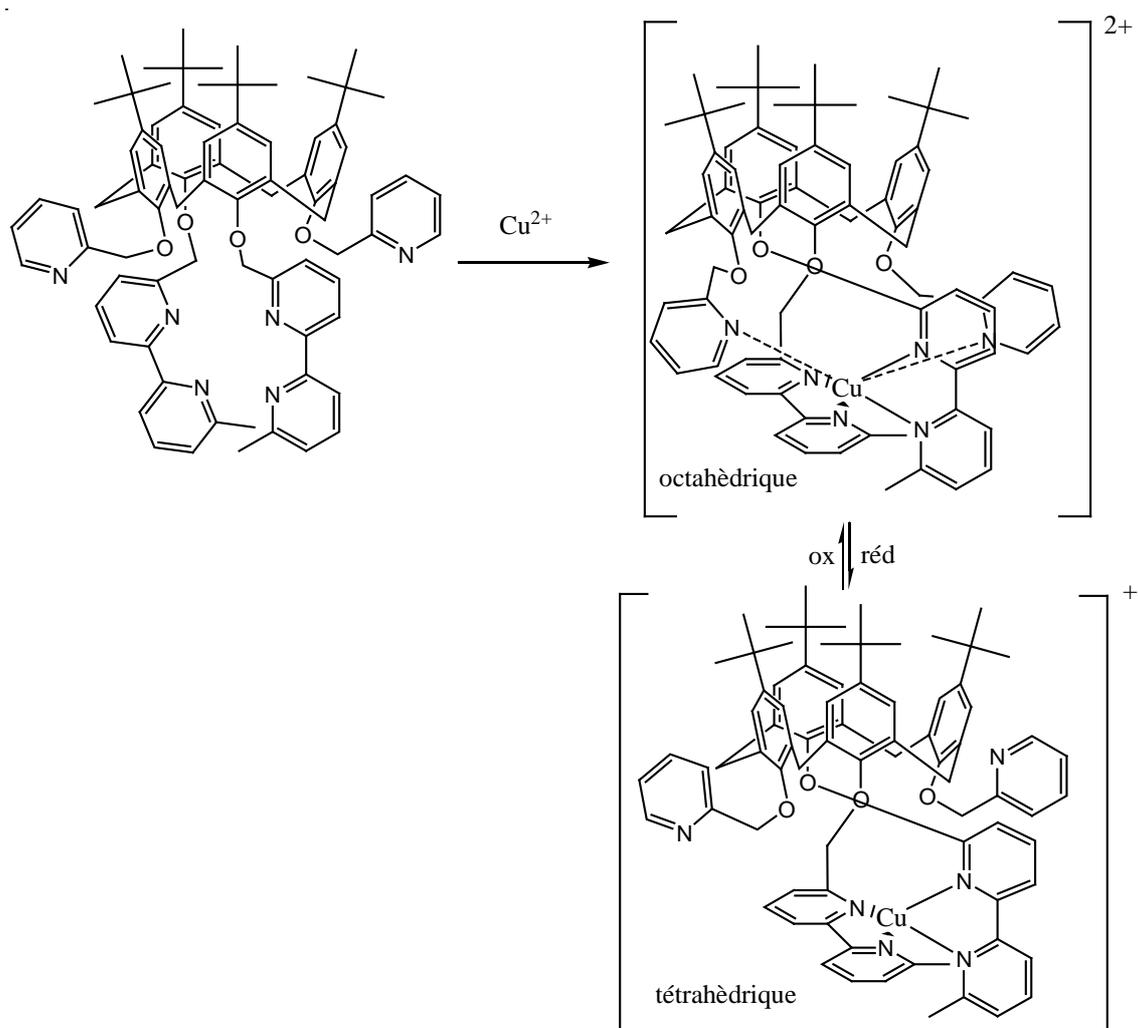
**Figure 41** : Ligand versatile : recherche d'une coordination tétraédrique (Cu(I)) et d'une coordination octaédrique (Cu(II)) [29]
