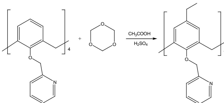
**Figure 52** : Résine calixarénique obtenue à partir du 25,26,27,28-tetrakis(2-pyridylméthoxy)calixarène [18].
