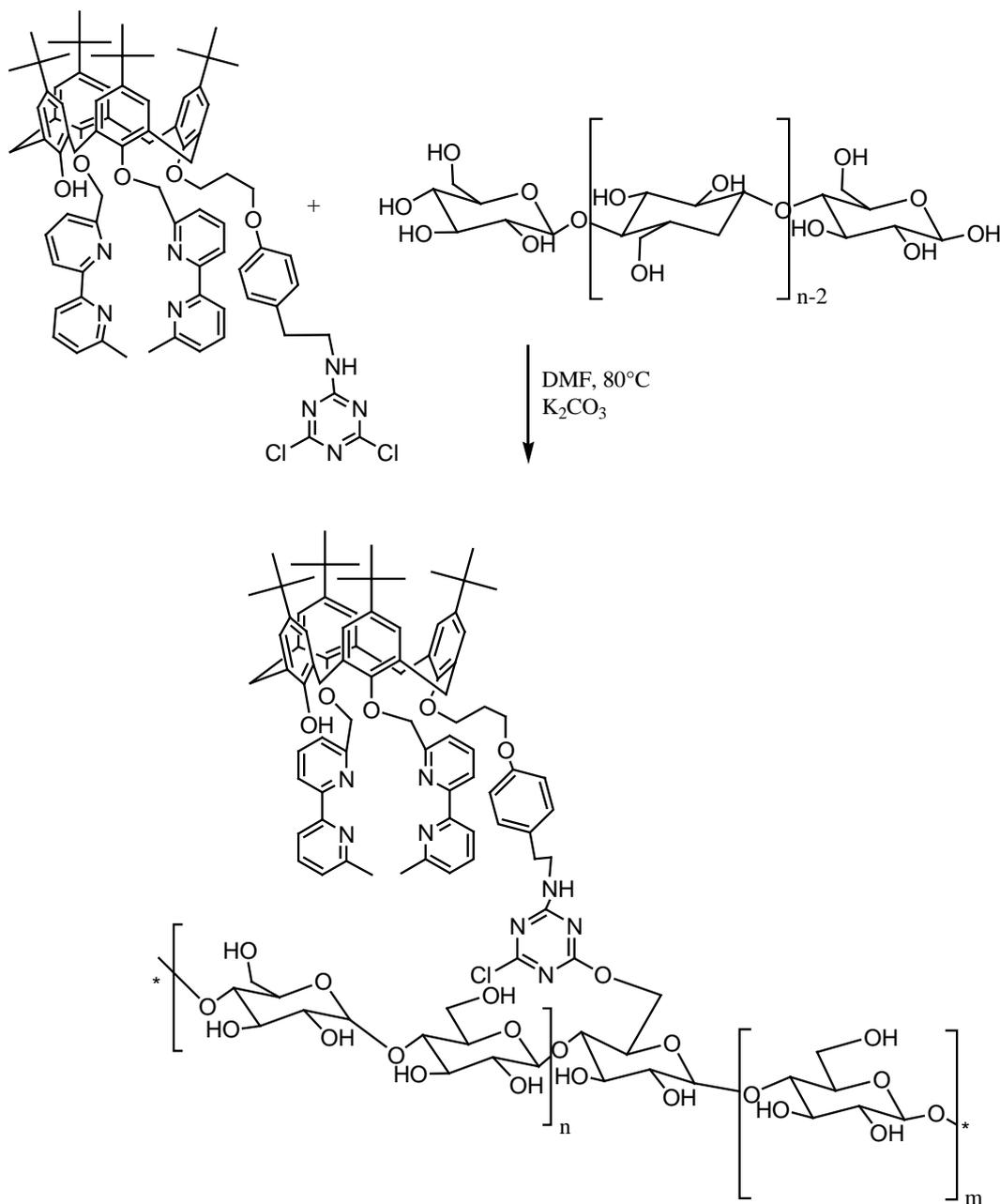
**Figure 134** : Greffage de l'intermédiaire calixarénique **20** sur la cellulose
