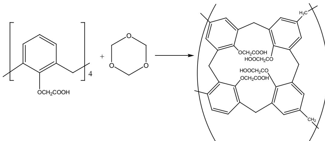
**Figure 51** : Polymérisation du calix[4]arène par le trioxane [17].
