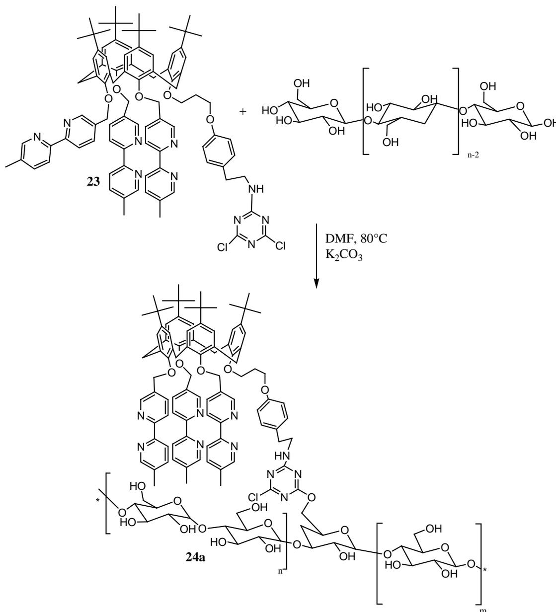
**Figure 135** : Greffage de l'intermédiaire calixarénique **23** sur la cellulose
