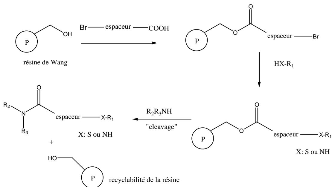
**Figure 108 :** Exemple de synthèse en phase solide
