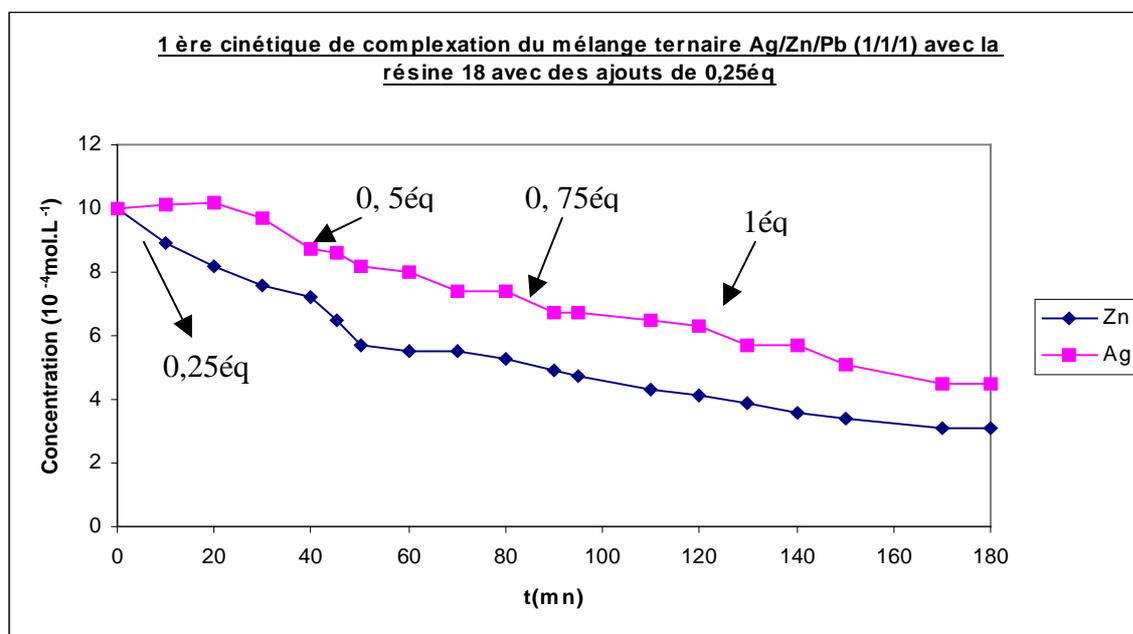
**Figure 143 :** Suivi cinétique par C.I de l'extraction par la résine **18** du mélange ternaire Ag,Zn,Pb (1,1,1) avec des ajouts de 0,25 équivalents à 0,40, 80 et 120 mn.
