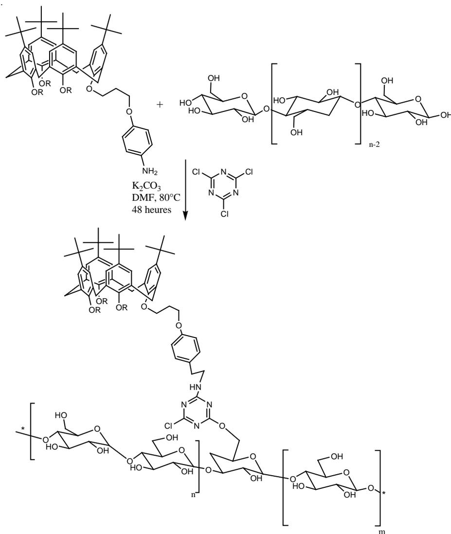
Figure 138 : Greffage « one-pot » sur cellulose
