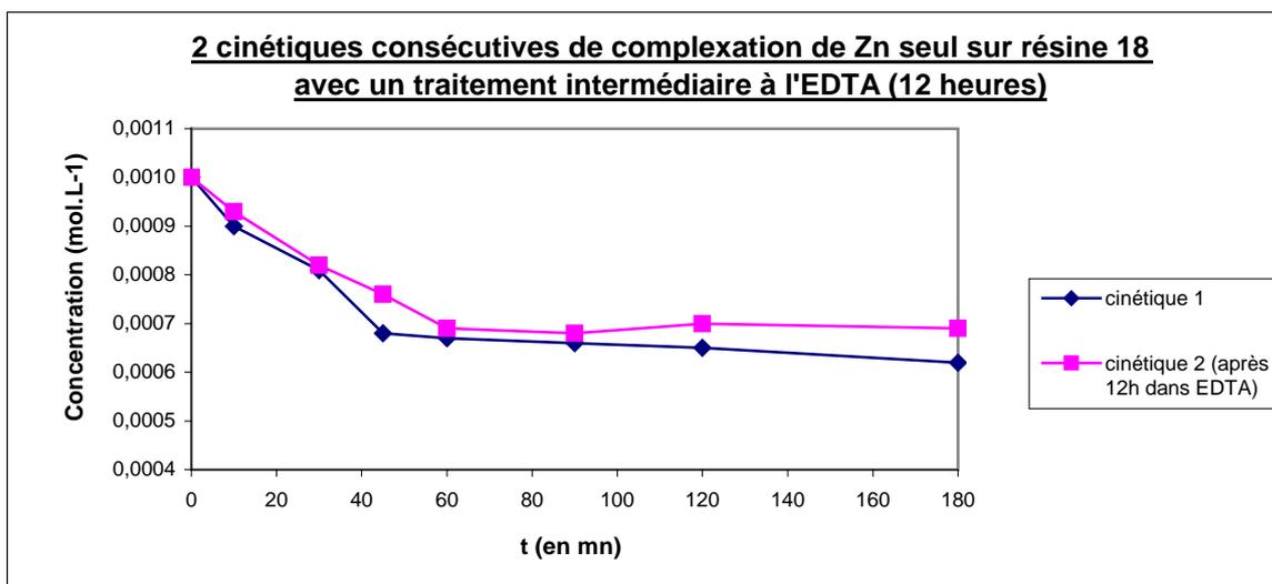
**Figure 152 :** Cinétiques consécutives sur l'extraction du zinc par la résine **18** (cinétique 1=cinétique initiale, cinétique 2 = cinétique après 12 heures de contact avec l'EDTA)
