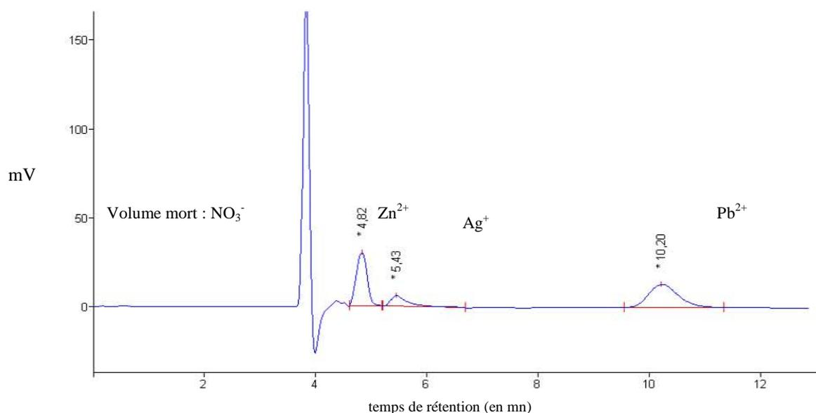
**Figure 139 :** Chromatogramme du mélange Ag,Zn,Pb avec  $[\text{Ag}(\text{NO}_3)] = [\text{Zn}(\text{NO}_3)_2] = [\text{Pb}(\text{NO}_3)_2] = 10^{-3} \text{ mol.L}^{-1}$
