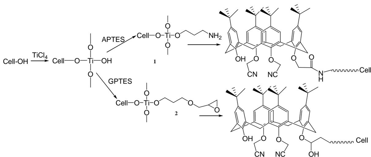
**Figure 57** : Fonctionnalisation de la cellulose [27].
