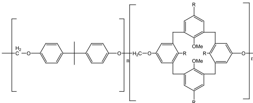
**Figure 47** : Copolymère obtenu par condensation sur le bisphénol-A [11,12].
