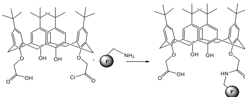
**Figure 68** : Greffage sur une résine PS-DVB aminométhylée [52].
