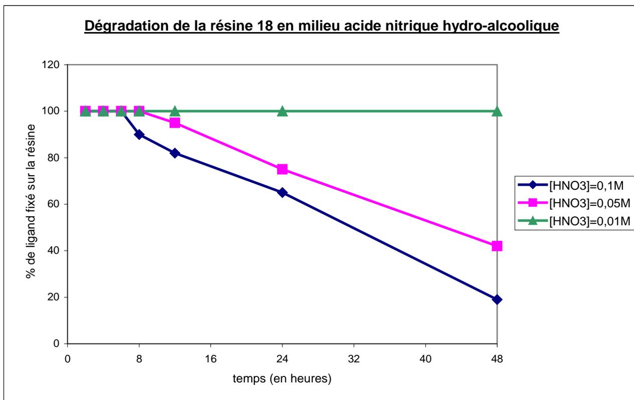
**Figure 160 :** Cinétique UV-visible de dégradation de la résine **18** en milieu acide nitrique hydro-alcoolique (MeOH/H<sub>2</sub>O 9/1)-suivi de la libération du calixarène **13**
