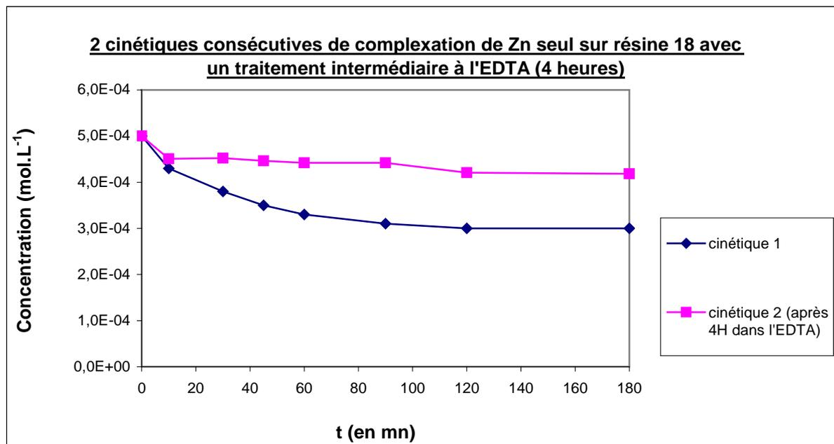
**Figure 151 :** Cinétiques consécutives sur l'extraction du zinc par la résine **18** (cinétique 1=cinétique initiale, cinétique 2 = cinétique après 4 heures de contact avec l'EDTA)
