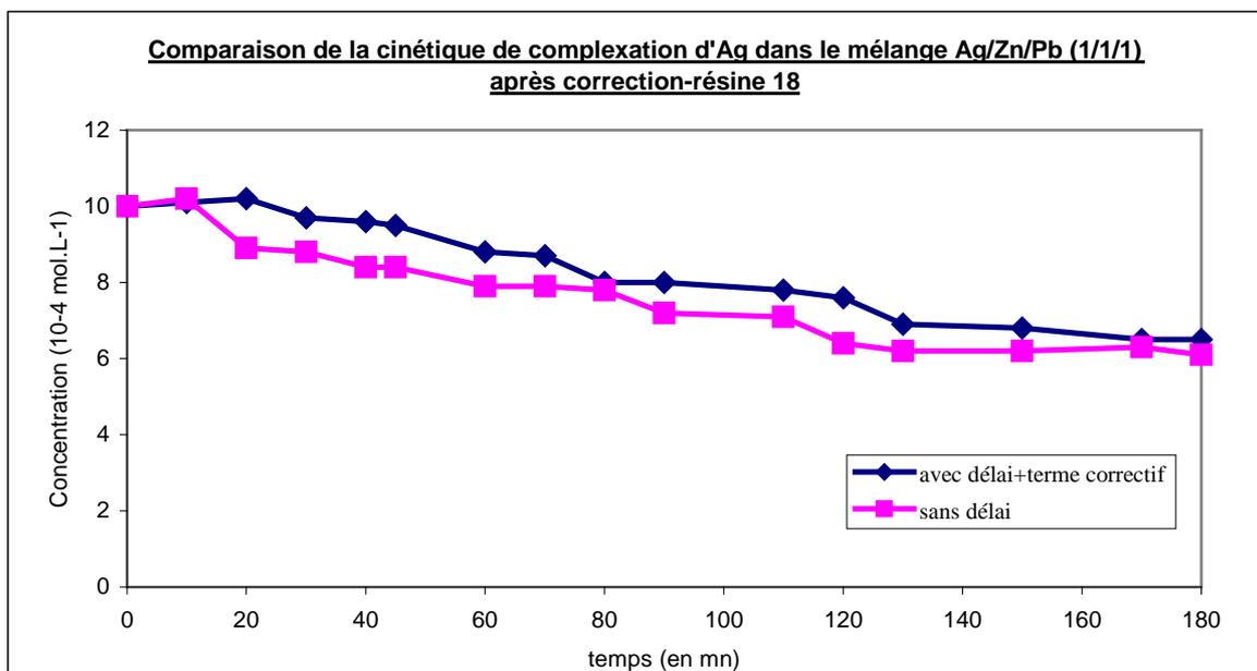
**Figure 148** : Comparaison des deux cinétiques de complexation d'Ag (sans délai, et avec délai+ terme correctif) par la résine **18**
