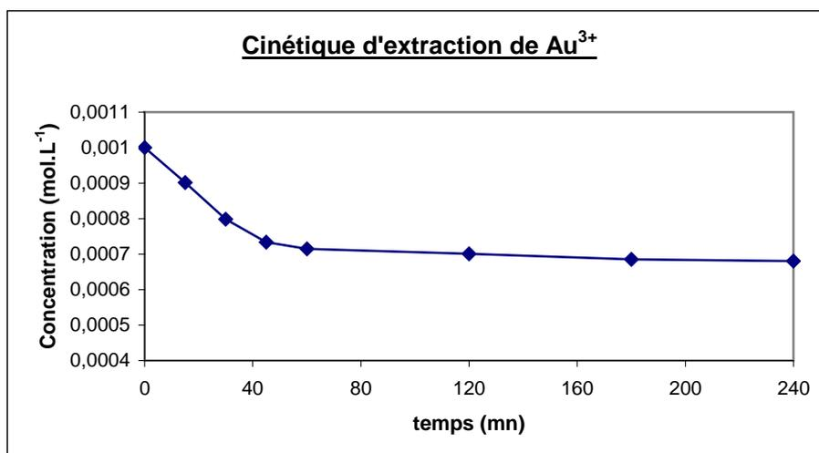
Figure 125 : Extraction de Au<sup>3+</sup> par la résine **18** suivie par chromatographie ionique
