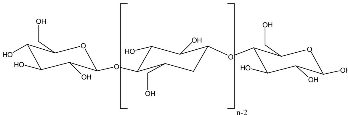
**Figure 5 :** Représentation de la chaîne cellulosique
