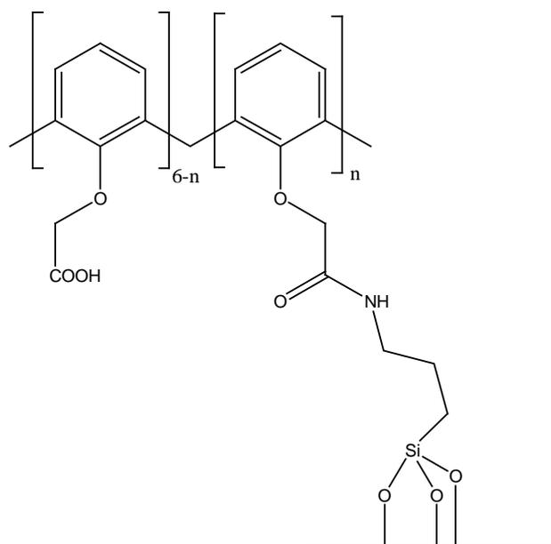
**Figure 54** : Calix[6]arène immobilisé sur gel de silice aminopropylé [21].
