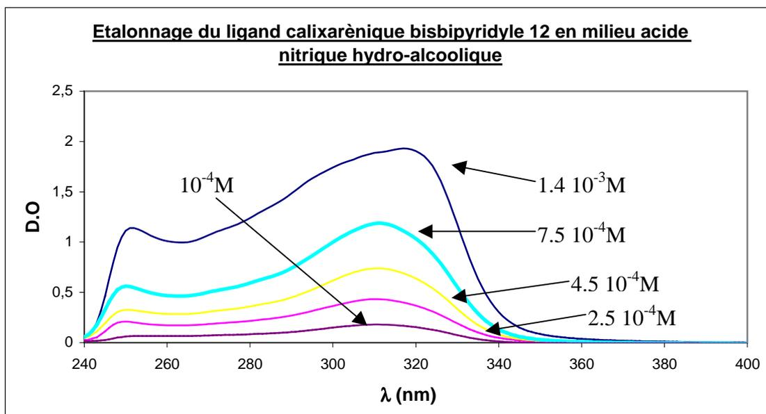
**Figure 158** : Etalonnage UV-visible du ligand calixarénique **12** en milieu acide nitrique hydro-alcoolique (MeOH/H<sub>2</sub>O 9/1; [HNO<sub>3</sub>] = 0,1M)
