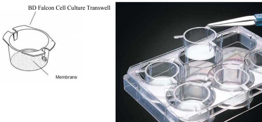
Figure 34 : Schéma du système de co-culture (BD Falcon TM ).
