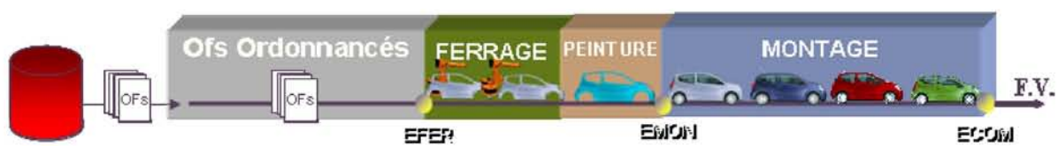
Figure 1-3 : Le flux Véhicule au sein d'une usine terminale
