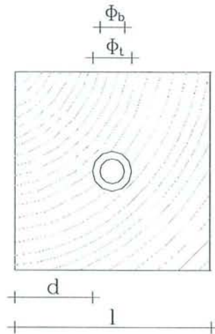
Figure 70 – Géométrie de l'éprouvette et montage dans l'appareillage d'extraction de la tige.
