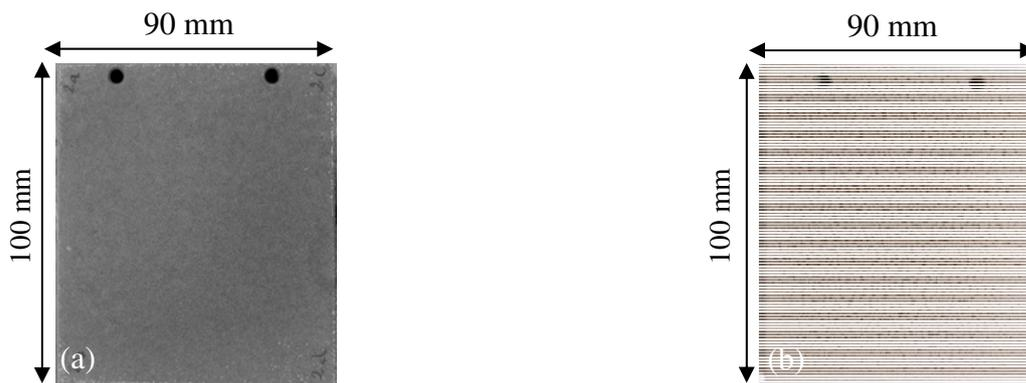
*Fig. III.1.1 : Photographies des pièces d'alliage 7050-T74 après transformation OMA en quatre séquences dans le bain aluminate (a) et dans le bain silicate (b)*
