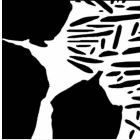
FIG. 3.20 – Microstructure initiale utilisée pour réaliser le calcul permettant de simuler la dissolution des précipités de phase \alpha au cours du chauffage dans le cas de l'alliage Ti17.
