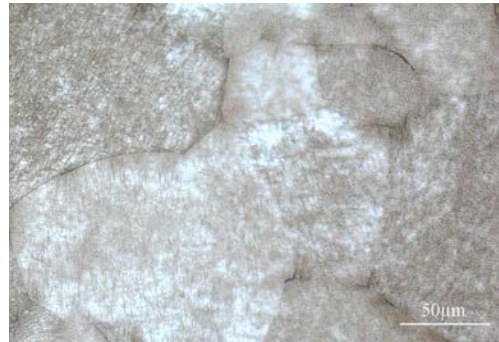
FIG. 4.24 – Micrographie optique de l'alliage Ti17 obtenue après un refroidissement continu à une vitesse de 0,61^\circ \text{C/s} .
