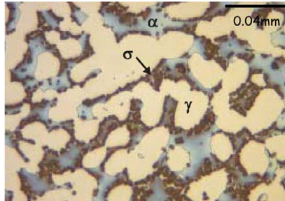
FIG. 1.15 – Microstructure obtenue par microscopie optique d'un échantillon d'acier inoxydable 2205 après attaque (avec une solution de KOH et eau), montrant les phases \gamma , \alpha et \sigma [43].
