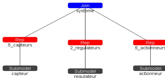
Figure 2.9 : Exemple d'utilisation des fonctions replicate et join
