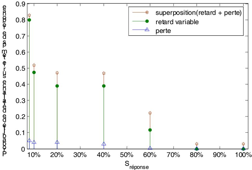
Figure 4.14 : Probabilité de défaillance par temps de réponse en fonction de la contrainte de seuil  $S_{réponse}$  (exprimé en pourcentage du temps de réponse normal) en présence des pertes, du retard variable et de la superposition des deux.
