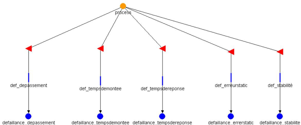
Figure 4.25 : Détection d'une défaillance en fonction des paramètres de performance de la boucle
