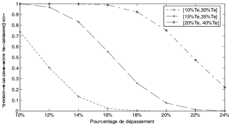
Figure 4.9 : Probabilité de défaillance par dépassement en présence des retards variables, l'axe des abscisses représente la contrainte de seuil  $D_{dep}$  (exprimé en % de la consigne), l'axe des ordonnées représente la valeur de la probabilité de défaillance
