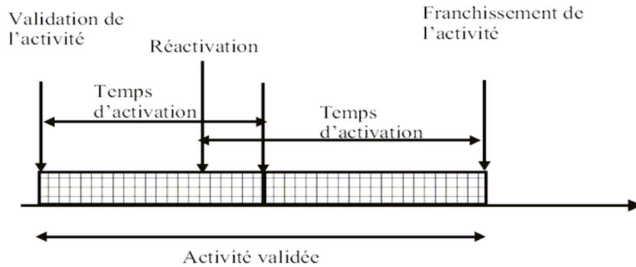
Figure 2.8 : Activation, réactivation, et franchissement des activités temporelles
