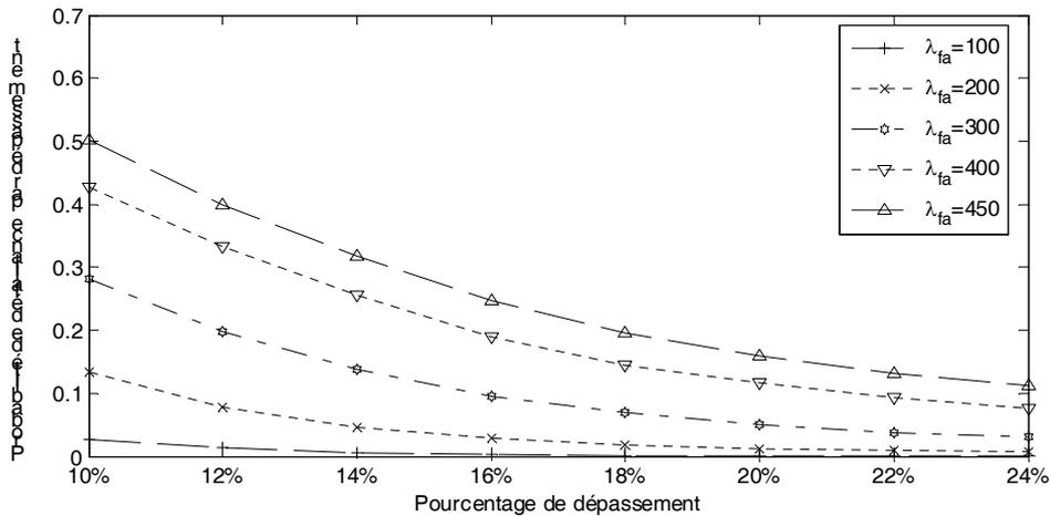
Figure 4.18 : Probabilité de défaillance par dépassement en fonction de la contrainte de seuil  $D_{dep}$  (exprimé en pourcentage de la consigne) pour plusieurs valeurs de  $\lambda_{fa}$  (taux d'arrivée des fautes).
