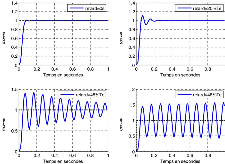
Fig. 3.18: Dépassement en sortie d'un SCR dû aux retards introduits par le réseau (la grandeur en abscisse est le temps en s).
