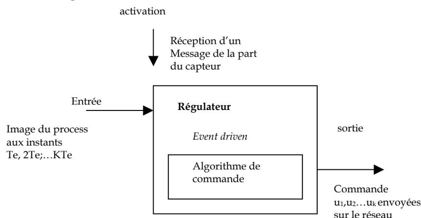
Figure 3.10 : Modèle du fonctionnement du régulateur
