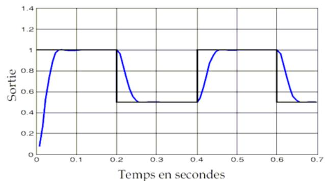
Figure 3.17 (b) réponse à un signal en créneaux
