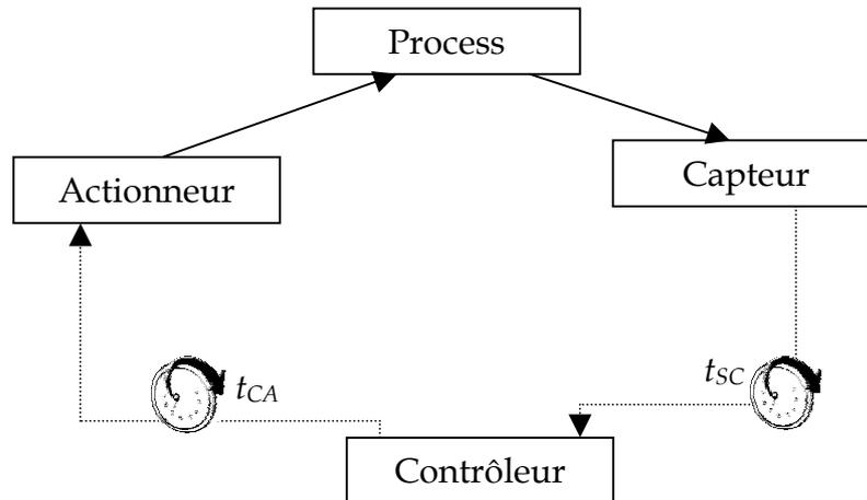
Figure 4.2 : Durées de transmission variables des informations envoyées
