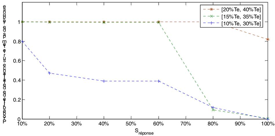
Figure 4.12 : Probabilité de défaillance par temps de réponse en fonction de la contrainte sur l'allongement  $S_{réponse}$  (exprimé en pourcentage du temps de réponse normal) pour différentes classes de variation du retard
