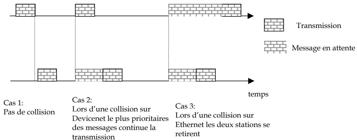
Figure 1.6 : Détections des collisions
