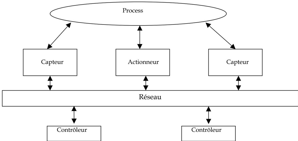
Figure 1.1 : Installation typique d'un SCR
