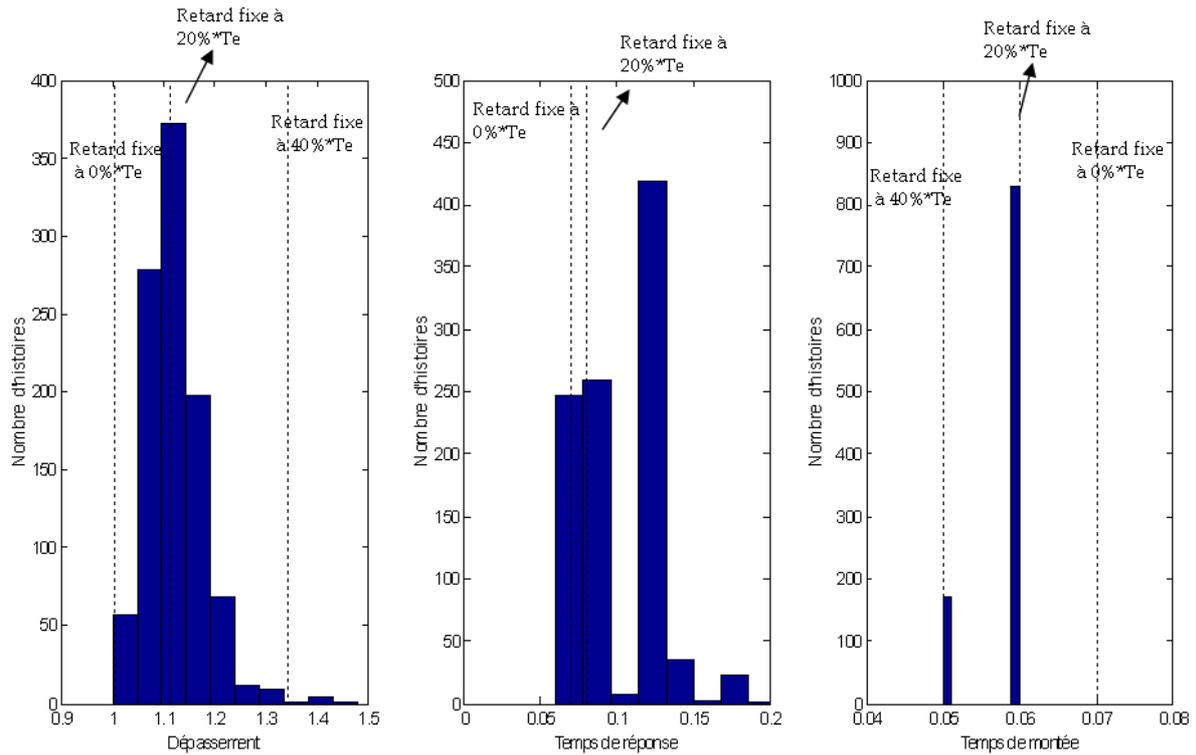
Figure 4.8 : Distribution du dépassement, du temps de réponse à 10% et du temps de montée en présence des retards variables et de perte des messages (l'axe des abscisses représente la valeur du paramètre de performance et l'axe des y représente le nombre d'histoires qui ont évolué vers la valeur donnée en abscisse)
