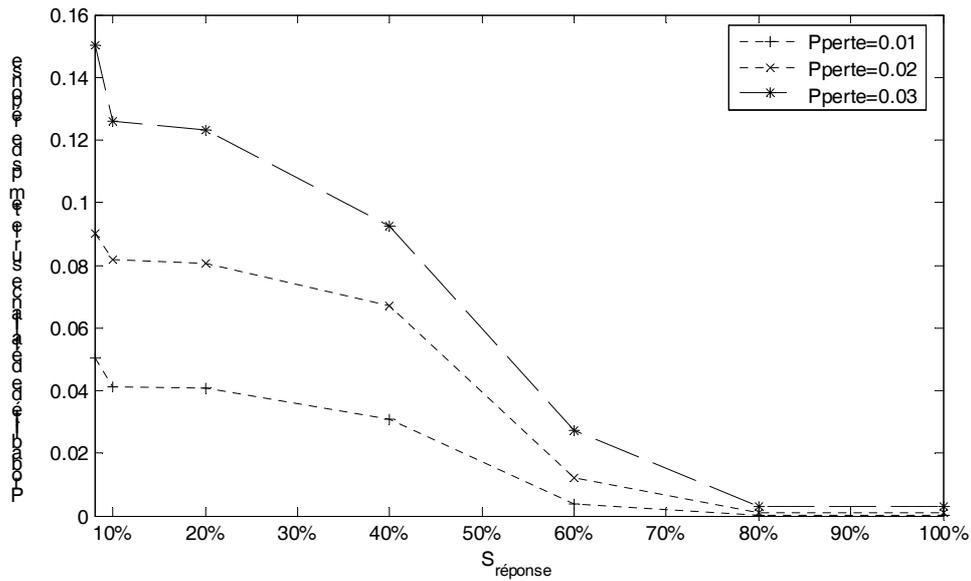
Figure 4.13 : Probabilité de défaillance par temps de réponse en fonction de la contrainte de seuil  $S_{réponse}$  (exprimé en pourcentage du temps de réponse normal pour différentes probabilités de pertes des informations)
