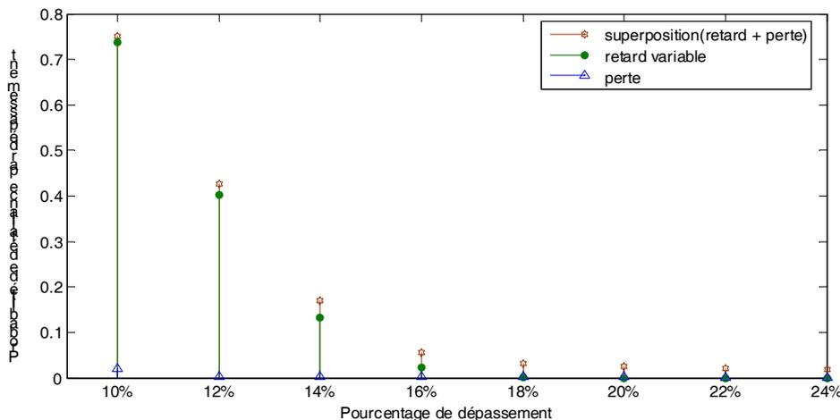
Figure 4.11 : Probabilité de défaillance par dépassement en présence des pertes et des retards variables, l'axe des abscisses représente la contrainte de seuil  $D_{dep}$  (exprimé en % de la consigne), l'axe des ordonnées représente la valeur de la probabilité de défaillance
