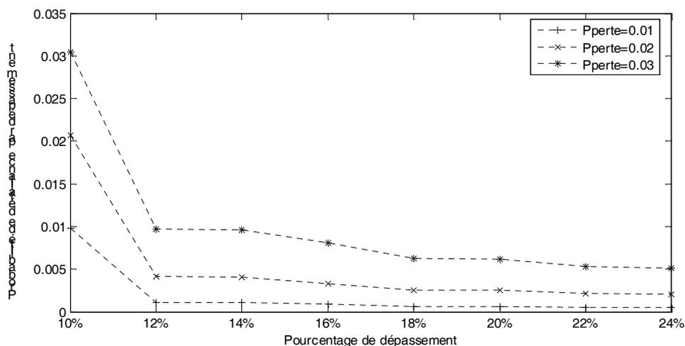
Figure 4.10 : Probabilité de défaillance par dépassement en présence des pertes sur les informations, l'axe des abscisses représente la contrainte de seuil  $D_{dep}$  (exprimé en % de la consigne), l'axe des ordonnées représente la valeur de la probabilité de défaillance
