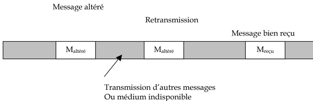
Figure 3.4 : Exemple d'une retransmission d'un message altéré
