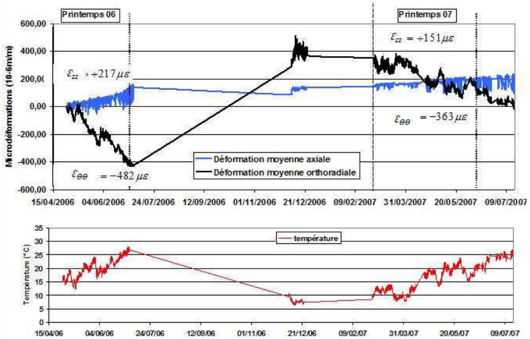
Figure 82 : Mesures moyennes en déformation axiale et orthoradiale et mesure de la température à la cellule 05, d'avril 2006 à juillet 2007.
