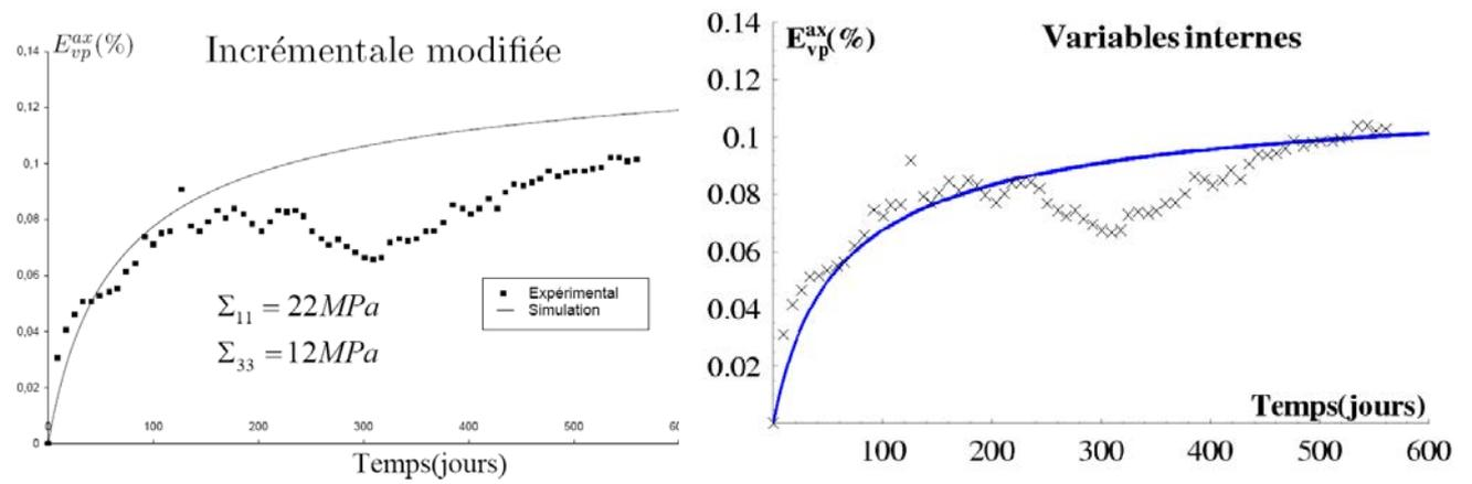
FIGURE V.21: Simulation d'essai de fluage triaxial de l'argilite de M/H-M
