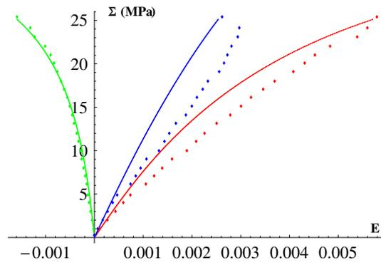
FIGURE IV.9: Essai de compression uniaxiale sur l'éprouvette EST05716-13
