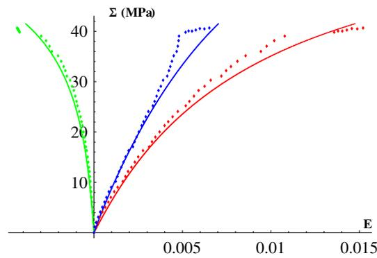
FIGURE IV.11: Essai de compression triaxiale sur l'éprouvette EST05716-11 avec la pression de confinement  $\sigma_{\text{conf}} = 10$  MPa
