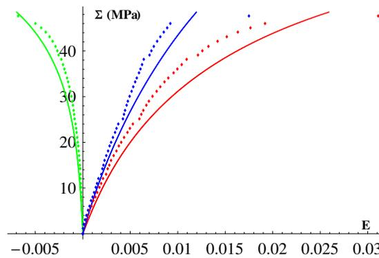
FIGURE IV.13: Essai de compression triaxiale sur l'éprouvette EST05736-10 avec la pression de confinement  $\sigma_{\text{conf}} = 20$  MPa
