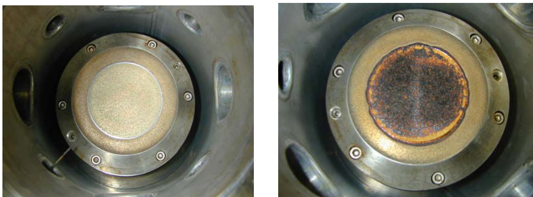
Figure II-18 : Photo du brûleur avant et après « charbonnage » dû au butylbenzène.
