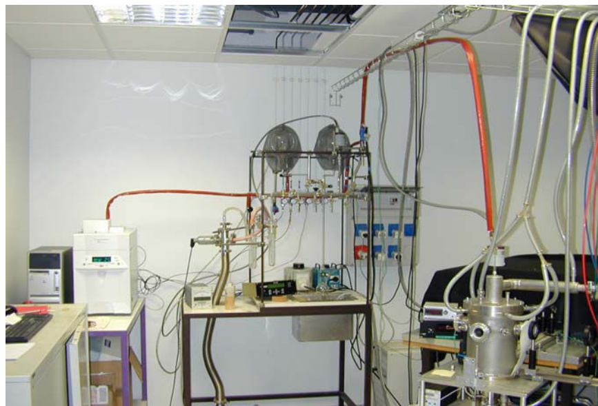
Figure II- 10 : Vue réelle du circuit de prélèvement et d'analyse des gaz de combustion.
