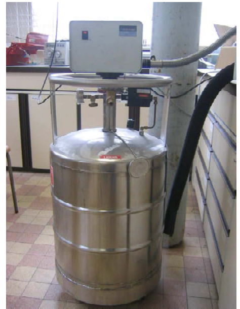
Figure 2.17.b. Groupe de froid Cryofill® permettant une analyse en mode subambiant.
