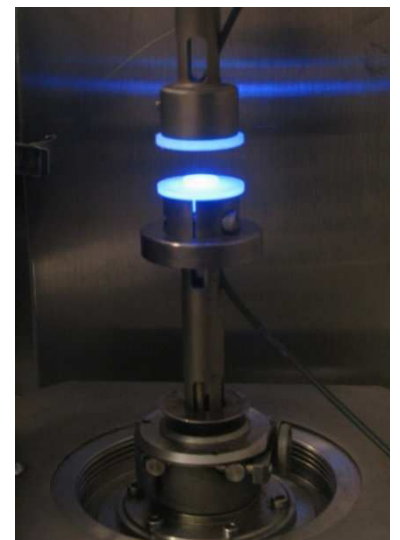
Figure 2.28. Insolation des plateaux en PVC via les fibres optiques (puissance d'irradiation : 50 \text{ mW.cm}^{-2} )
