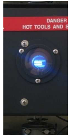
Figure 2.29. Echantillon ( \varnothing = 10 mm ; h = 1 mm) en cours d'essai
