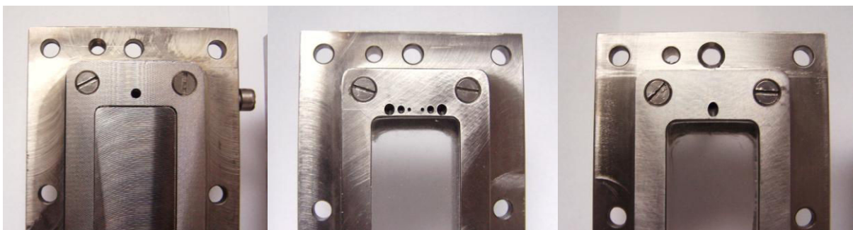
Figure F.14.2 : Photo détaillée des trois distributeurs de gaz. De gauche à droite : distributeur n°1, distributeur n°2 et distributeur n°3
