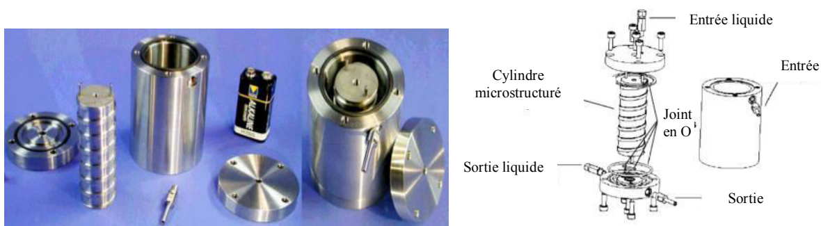
Figure II. 7: Microréacteur à film tombant à canal hélicoïdal (De Bellefon et al. , 2005)
