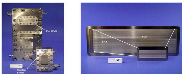
Figure VII. 4 : Photo du microréacteur à film tombant plat avec le microréacteur à film tombant standard (Vankayala et al. , 2007)
