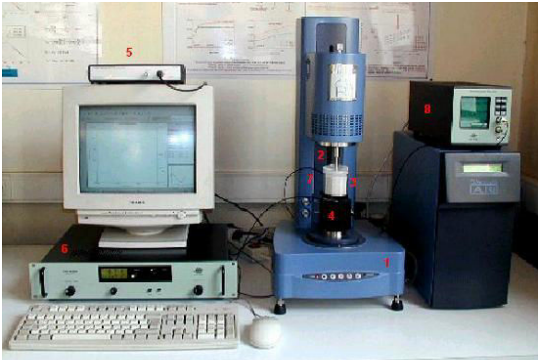
Figure I-43 Rhéomètre à poudres : 1. Rhéomètre. 2. Scissomètre. 3. Cuve et chicanes. 4. Mini-vibreur. 5. Générateur de signaux. 6. Amplificateur de puissance. 7. Accéléromètre. 8. Amplificateur de mesure.
