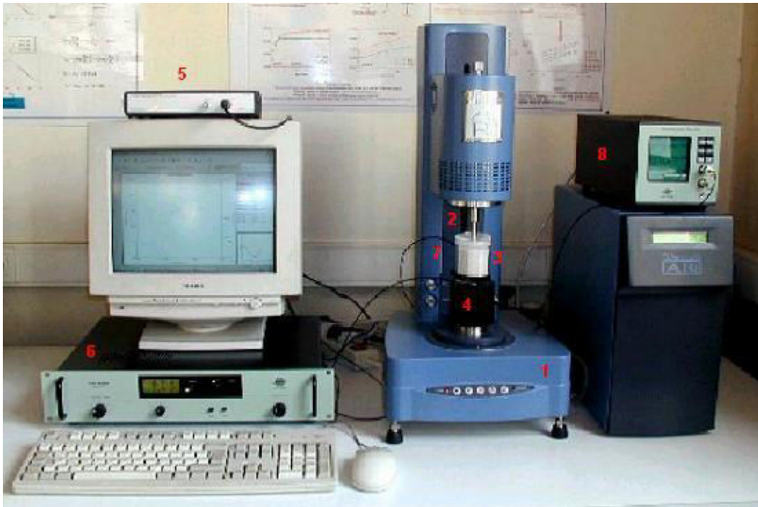
Figure I-43 Rhéomètre à poudres : 1. Rhéomètre. 2. Scissomètre. 3. Cuve et chicanes. 4. Mini-vibreux. 5. Générateur de signaux. 6. Amplificateur de puissance. 7. Accéléromètre. 8. Amplificateur de mesure.
