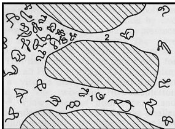
Figure I-29 Formation de gradients de concentration par convection. (1) le polymère passe le pore aisément, (2) accumulation de polymère dans un pore étroit.
