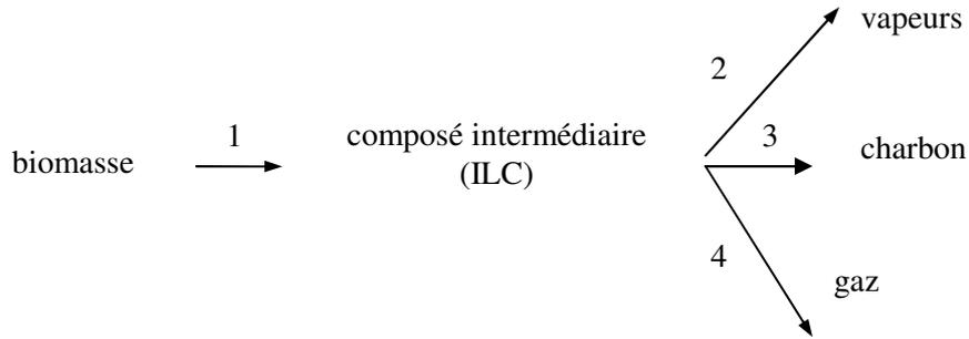
Figure V.1 Schéma de décomposition de la biomasse à haut flux de chaleur [Broust, 2003 ; Kohler 2009]
