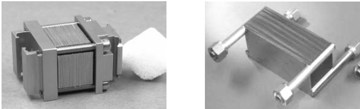
Figure I.1. Assemblage de plaques microstructurées en acier inoxydable, disposées pour une opération de transfert de chaleur à courants croisés (à gauche) et à contre courant (à droite).
