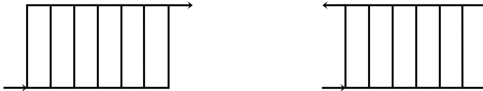
Figure I.3. Canaux parallèles arrangés en configuration Z (à gauche) et en configuration U (à droite).
