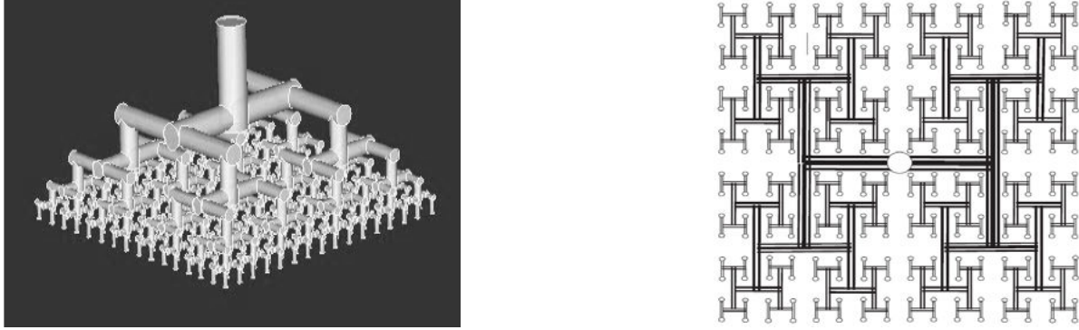
Figure I.2. Distributeur arborescent pour la distribution du fluide à travers un réseau de microcanaux (perspective 3D et vue de dessus).
