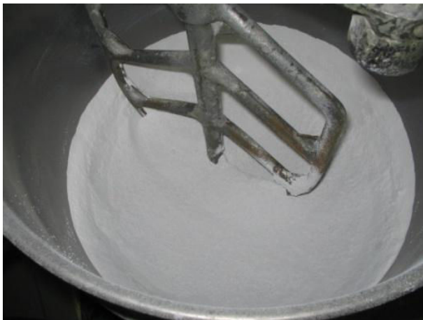
Fig. 88 : Malaxage du mélange pulvérulent (béton).
