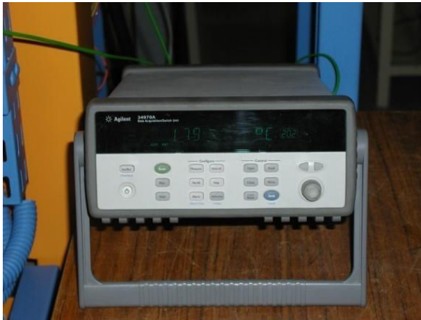
Fig. 93 : Centrale d'acquisition de la température (Agilent 39A).
