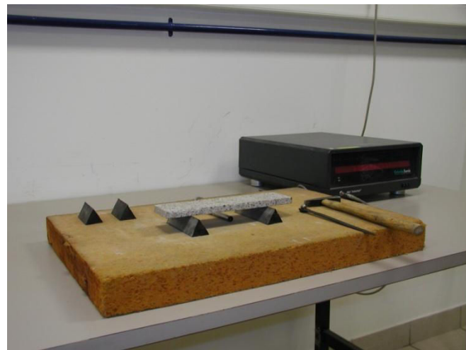
Fig. 38 : Photo du dispositif de mesure des caractéristiques mécaniques par résonance.
