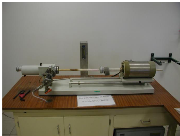
Fig. 43 : Photo du dispositif de mesure de la dilatation thermique.
