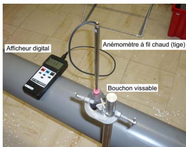
FIG. 3.7 – Anémomètre à fil chaud et son afficheur
