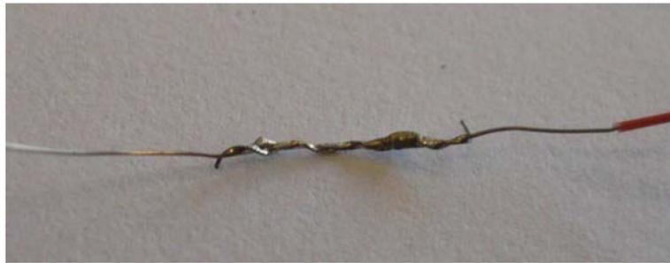
FIG. 3.11 – Soudure d'un thermocouple
