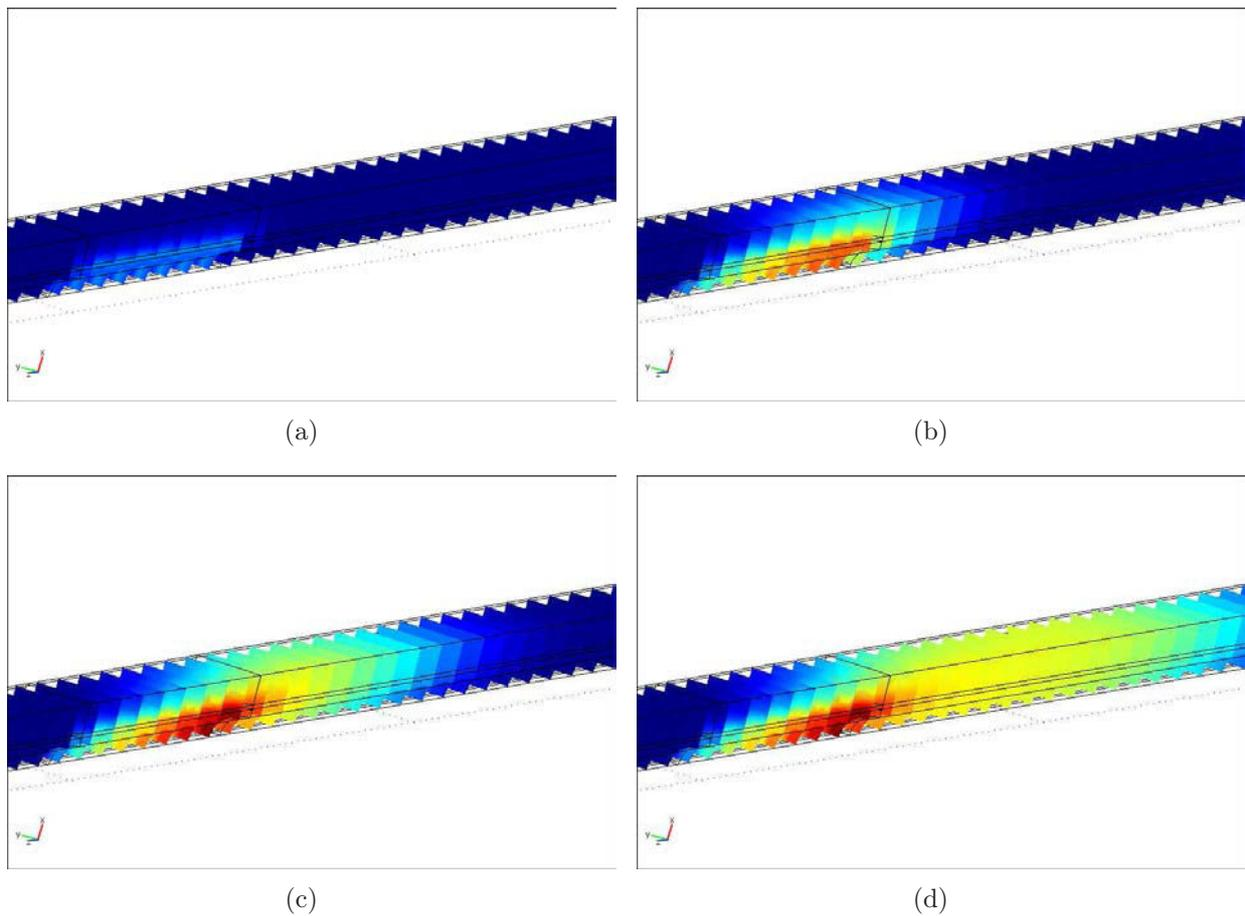
FIG. 5.24 – Evolution temporelle du champ de température en géométrie cylindrique.(a) Champ à  $t = 40sec$ .(b) Champ à  $t = 270sec$ .(c) Champ à  $t = 580sec$ .(d) Champ à  $t = 1000sec$ .
