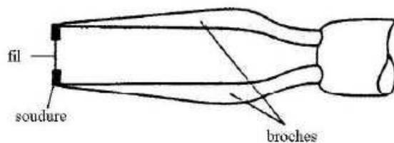
FIG. 3.6 – Schéma simplifié d'un anémomètre à fil chaud
