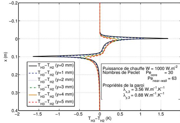
FIG. 2.15 – Comparaison entre les modèles à deux couches et à trois couches
