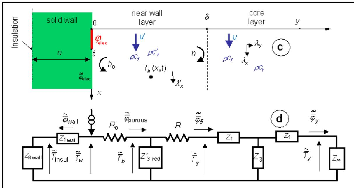
FIG. 2.16 – Représentation schématique du modèle à trois couches réduit sous forme de quadripôles thermiques
