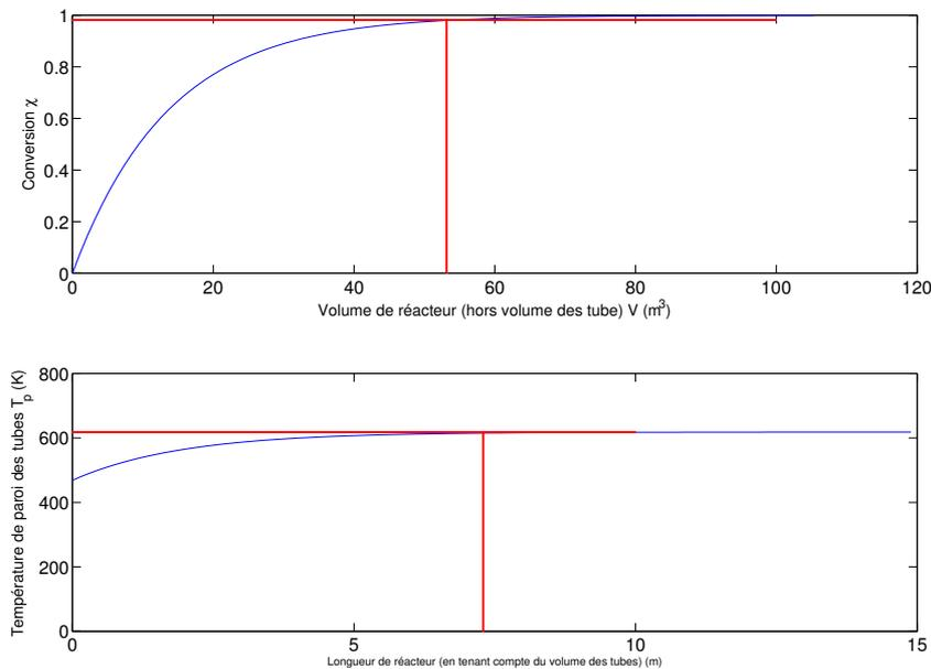
FIG. 5.4 – Evolution de la conversion et de la température de paroi des tubes refroidissants le long du réacteur-échangeur
