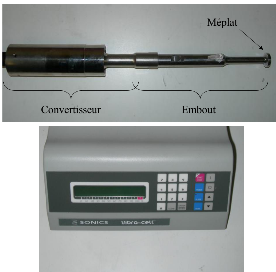
Figure 4.11 Injecteur ultrasonique « Sonics » et son alimentation
