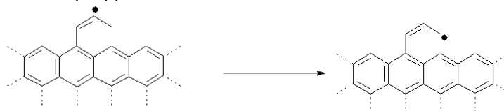
Figure 4-8°: Réaction d'isomérisation sur l'espèce CHC.CH_3z(S)
