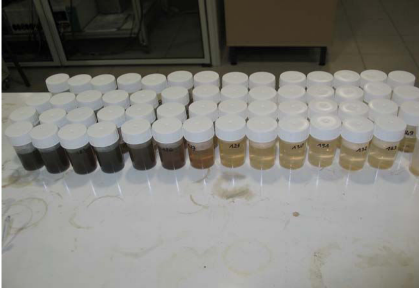
Figure II-5: Présentation d'échantillons (en première rangée visible, on observe l'effluent station traité aux électrodes de fer à la densité de courant de 200A/m^2 et échantillonnés à 1,2,3,4,5,7,10,15,20,25,30,40,50,60 min respectivement de gauche à droite)
