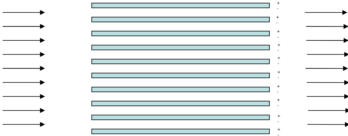
Figure V-6 : Cellule électrochimique en mode bipolaire (Chen, 2004)
