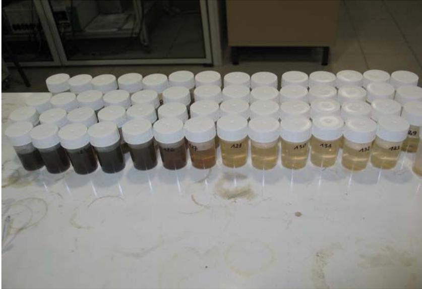
**Figure II-5: Présentation d'échantillons (en première rangée visible, on observe l'effluent station traité aux électrodes de fer à la densité de courant de  $200A/m^2$  et échantillonnés à 1,2,3,4,5,7,10,15,20,25,30,40,50,60 min respectivement de gauche à droite)**
