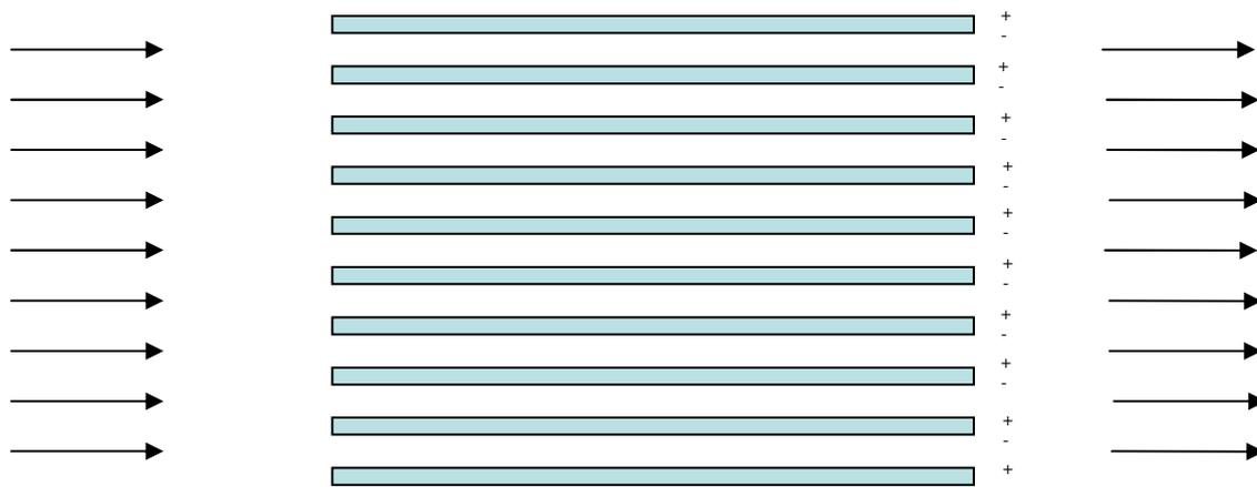
**Figure V-6 : Cellule électrochimique en mode bipolaire (Chen, 2004)**
