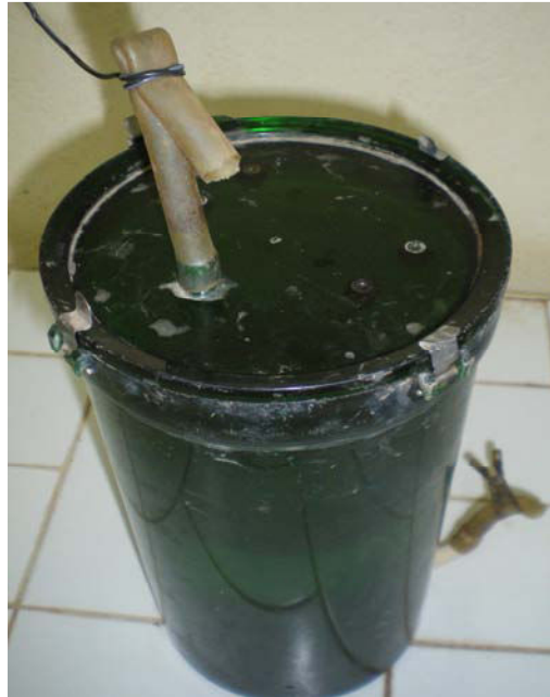
Figure V-2 : bocal de traitement anaérobie (au laboratoire de l'IRSAT).
