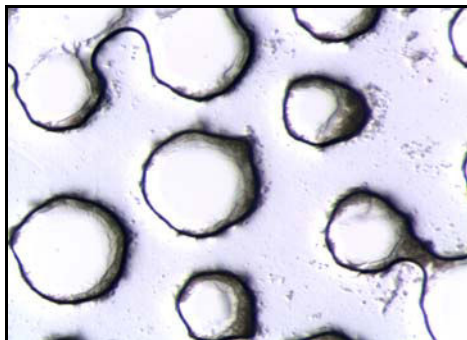
c) Dépôt par drainage de \text{CO}_2 (écoulement de la droite vers la gauche)
