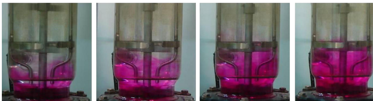
Figure III-14 Influence du débit dans la zone de mélange du lit fluidisé (de gauche à droite) : Q_A = Q_B = 10 \text{ L/h} , Q_A = Q_B = 20 \text{ L/h} , Q_A = Q_B = 30 \text{ L/h} , Q_A = Q_B = 40 \text{ L/h}
