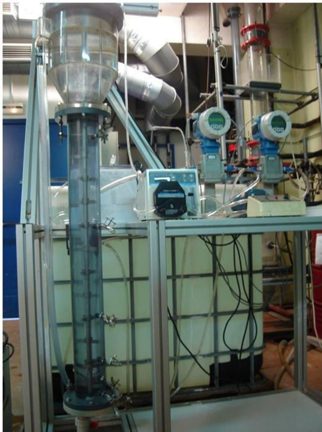
Figure IV-1 Modification réalisées sur le réacteur à lit fluidisé
