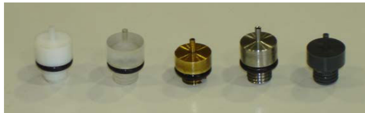
Figure 2.2 - Photographie des buses en différents matériaux pour la formation de gouttes (dans l'ordre de la photographie : teflon, PMMA, laiton, acier inoxydable, PVC)
