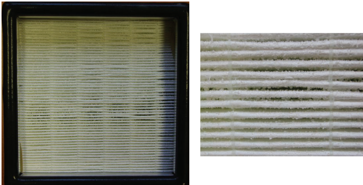
Figure 3–32 : Photographies de la surface (à gauche) et d'une partie de cette surface (à droite) d'un filtre plissé après un colmatage avec un aérosol de chlorure de sodium à 2,7 \text{ cm.s}^{-1} jusqu'à environ 57 \text{ g.m}^{-2} et à un taux d'humidité relative de 70 %
