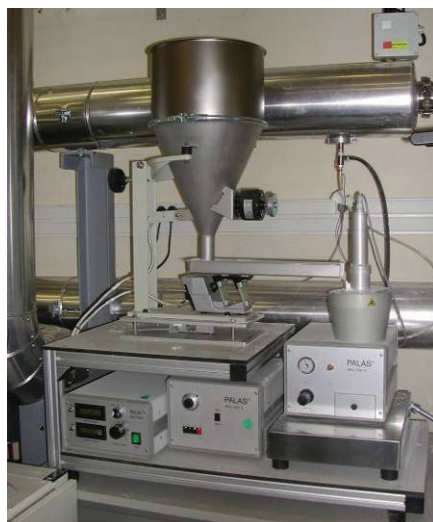
Figure 2-8 : Générateur par dispersion de poudre PALAS BEG-1000
