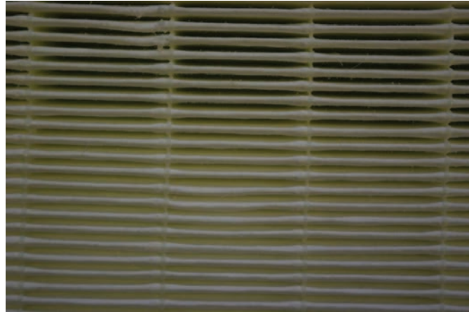
Figure 3–33 : Photographie d'une partie de la surface d'un filtre plissé après un colmatage avec l'aérosol de chlorure de sodium effectué à 2,7 \text{ cm.s}^{-1} jusqu'à environ 110 \text{ g.m}^{-2} et à un taux d'humidité relative de 79 % (supérieur au point de déliquescence des particules)
