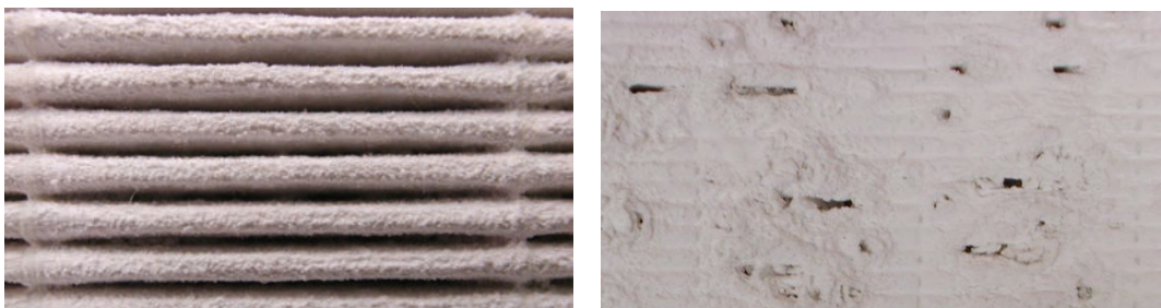
Figure 3–29 : Photographies d'une partie de la surface de deux filtres plissés après un colmatage à 2,6 \text{ cm.s}^{-1} , jusqu'à environ 100 \text{ g.m}^{-2} de particules d'alumine et à deux taux d'humidité relative de l'air différents : à gauche de 5 % et à droite 100 %
