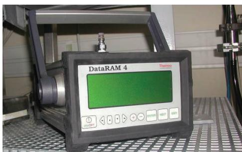
Figure 2–12 : Photographie du néphélomètre
