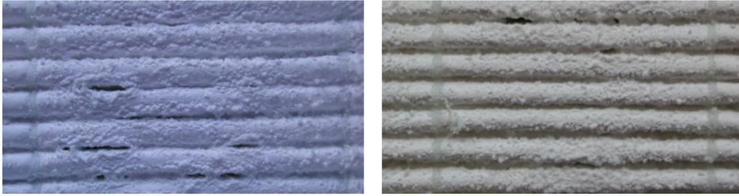
Figure 3–31 : Photographies d'une partie de la surface de deux filtres plissés après un colmatage avec l'aérosol de chlorure de sodium effectué à  $2,7 \text{ cm.s}^{-1}$  jusqu'à environ  $70 \text{ g.m}^{-2}$  et pour deux taux d'humidité relative différents : à gauche 5 % et à droite 50 %
