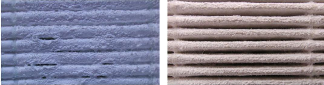
Figure 3–30 : Photographies d'une partie de la surface de deux filtres plissés après un colmatage à  $2,7 \text{ cm.s}^{-1}$  et 5 % d'humidité relative avec deux aérosols différents : à gauche chlorure de sodium jusqu'à  $70 \text{ g.m}^{-2}$  et à droite alumine jusqu'à  $95 \text{ g.m}^{-2}$
