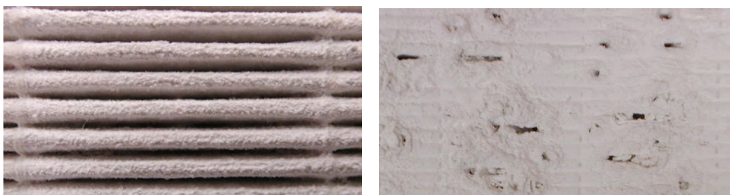
Figure 3–29 : Photographies d'une partie de la surface de deux filtres plissés après un colmatage à 2,6 \text{ cm.s}^{-1} , jusqu'à environ 100 \text{ g.m}^{-2} de particules d'alumine et à deux taux d'humidité relative de l'air différents : à gauche de 5 % et à droite 100 %
