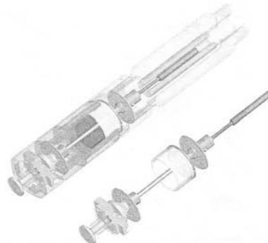
**Figure B.7:** Schéma de principe de l'instrument d'indentation TeMPeST
