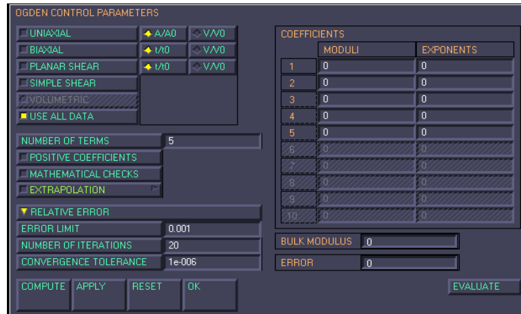
Figure C.1: Interface du programme de lissage des courbes expérimentales sous Marc Mentat, dans le cas d'identification des modules et des coefficients exponentiels \alpha_i d'Ogden
