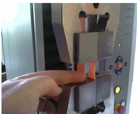
Figure III.10: Éprouvette rectale en phase de relaxation suite à la traction. A ce stade, comme au stade suivant immédiatement la pré-tension, les dimensions de l'éprouvette sont facile à mesurer par le biais d'un pied à coulisse.
