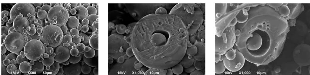
FIGURE C.27 – Images micrographiques des capsules faites à un débit de phase oranique de 4 ml/min et un débit de phase aqueuse de 20 ml/min dans le micromélangeur avec une concentration en PVA de 3%<sub>w</sub>.
