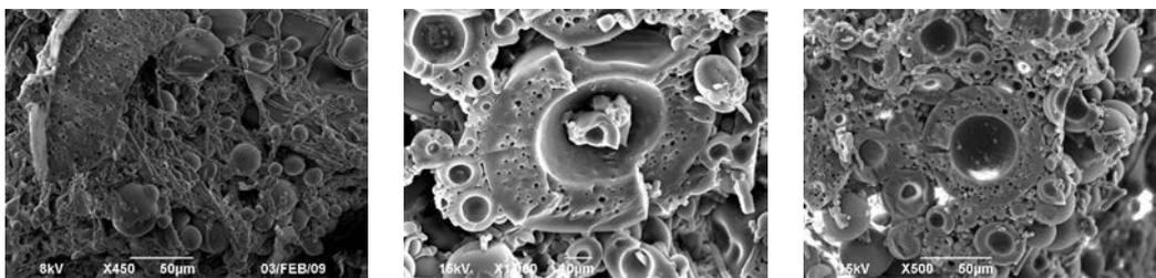
FIGURE C.29 – Images micrographiques des capsules faites à un débit de phase oranique de 2 ml/min et un débit de phase aqueuse de 30 ml/min dans le micromélangeur avec une concentration en PVA de 3%<sub>w</sub>.
