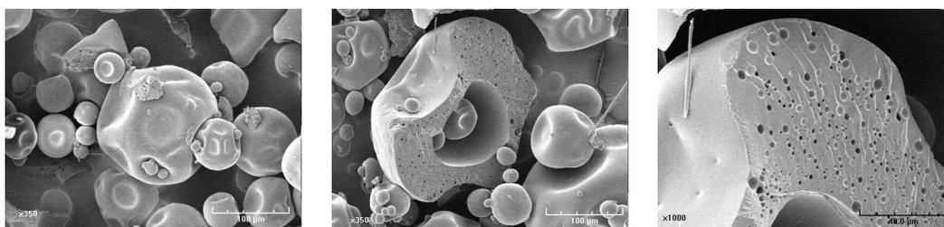
FIGURE C.21 – Images MEB de capsules faites avec une solution initiale organique à 10%<sub>w</sub> en polymère, avec un diamètre d'injection de 0,5 mm et un débit de phase continue de 60 ml/min.
