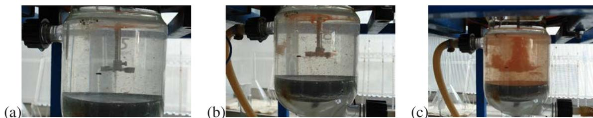
FIGURE 3.3 – Visualisation de l'accumulation de capsules autour de l'agitateur dans le cas d'une injection au-dessus de la surface libre.
