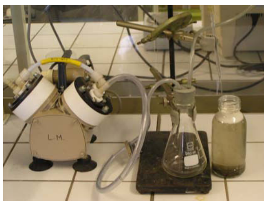
Figure 23 : Système d'aspiration sous vide du Tenax flottant à la surface de la suspension.
